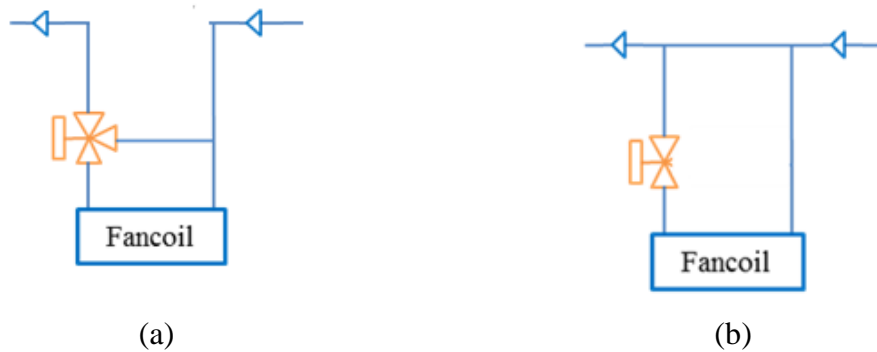
Figura 8.3 (a) - Esquema hidráulico com válvula de três vias. (b) - Esquema hidráulico com válvula de duas vias.
