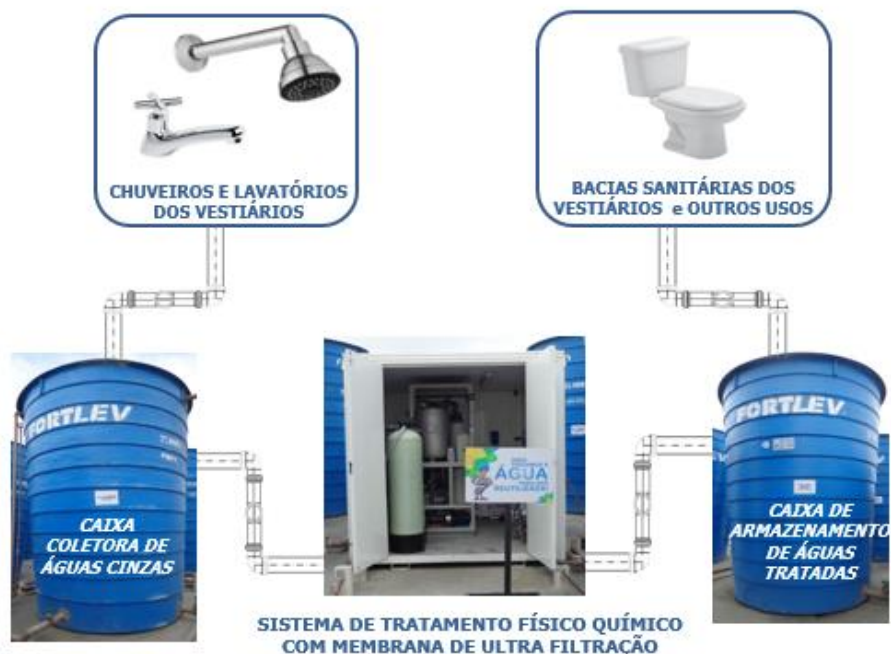
Figura 36 - Esquema da estação de tratamento das águas cinzas (fonte: Relatório Ilha Pura, 2015)
