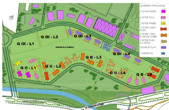
Figura 26: Lotes e Tipologias das Edificações - 1ª Fase Ilha Pura (fonte: Relatório Ilha Pura, 2012)
