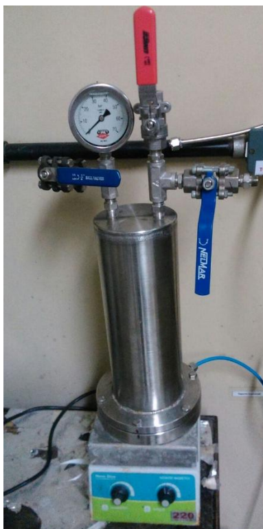
Figura 3.8: Foto do equipamento de filtração por membranas utilizadas no Fracionamento. (Fonte própria)
