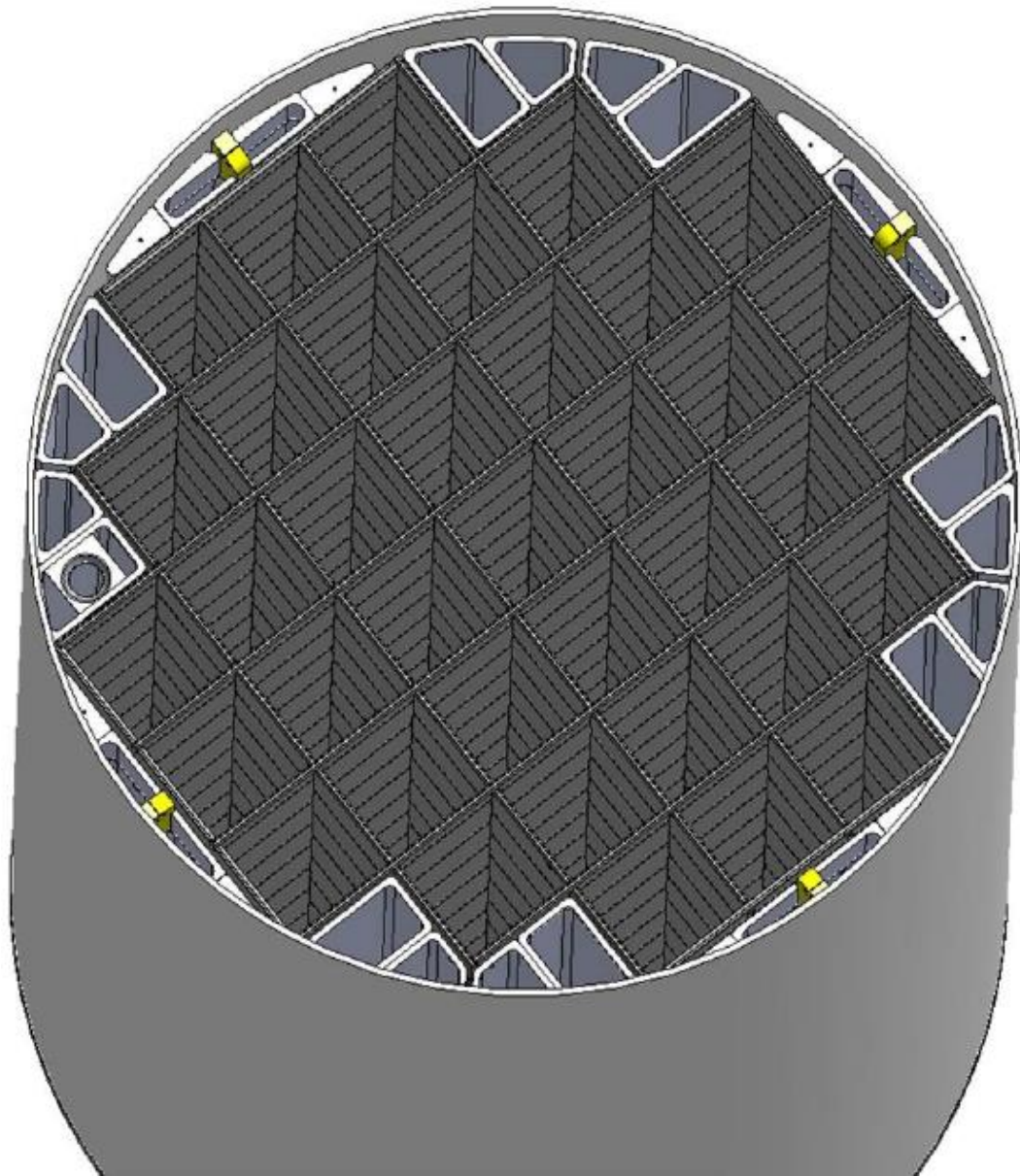
Figura 8: Cesto de Combustíveis PWR do MPC-37 (37 células de armazenamento). [4]
