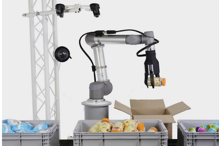
Figura 24 – Robô realizando tarefa Pick-and-place
