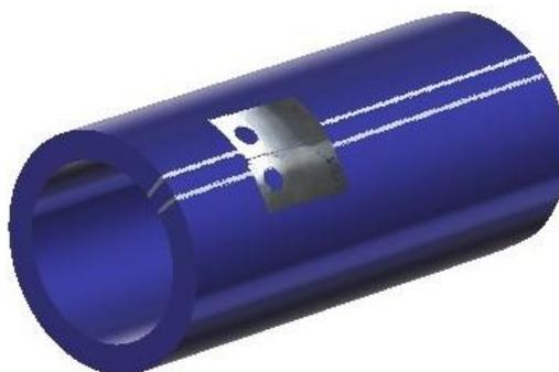
Figura 21: Representação, sem escala, da orientação CL dos corpos de prova.
