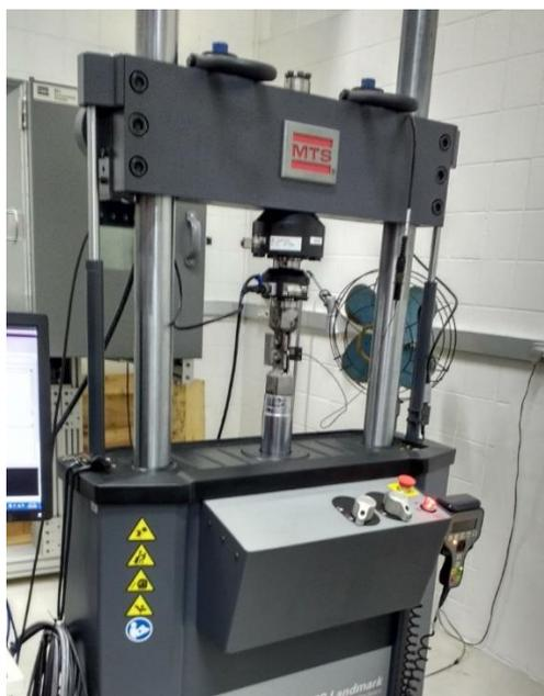
Figura 23: Servo Hidráulica MTS Landmark do Laboratório de Fratura da COPPE-UFRJ.
