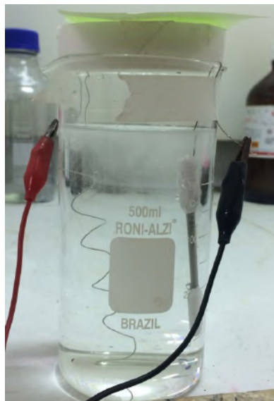
Figura 3.4: Aparato utilizado para a hidrogenação eletrolítica de um corpo de prova de tração.
