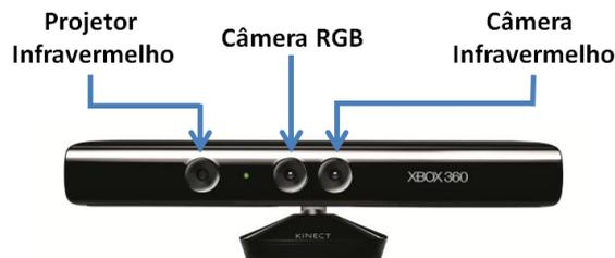
Figura 2.4: Composição dos sensores no *kinect* Fonte: de Lima [5], pp.37
