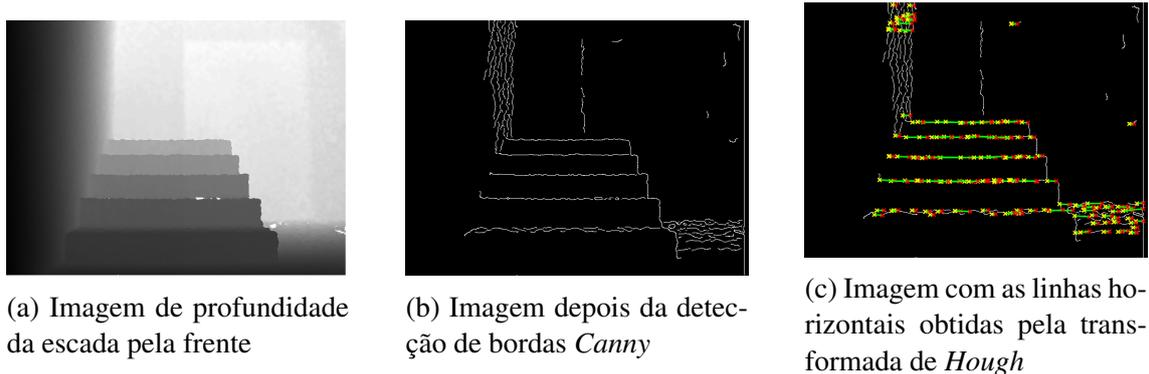
Figura 4.2: Passo a passo do método de detecção das linhas
