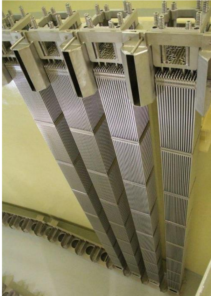
Figura 4. Elementos combustíveis de Angra II (Adaptado de [25]).
