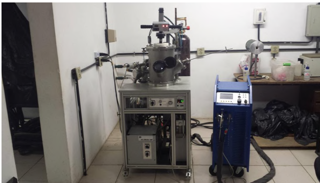
Figura 19. Forno à arco elétrico Buhler AM-VARIO 400.
