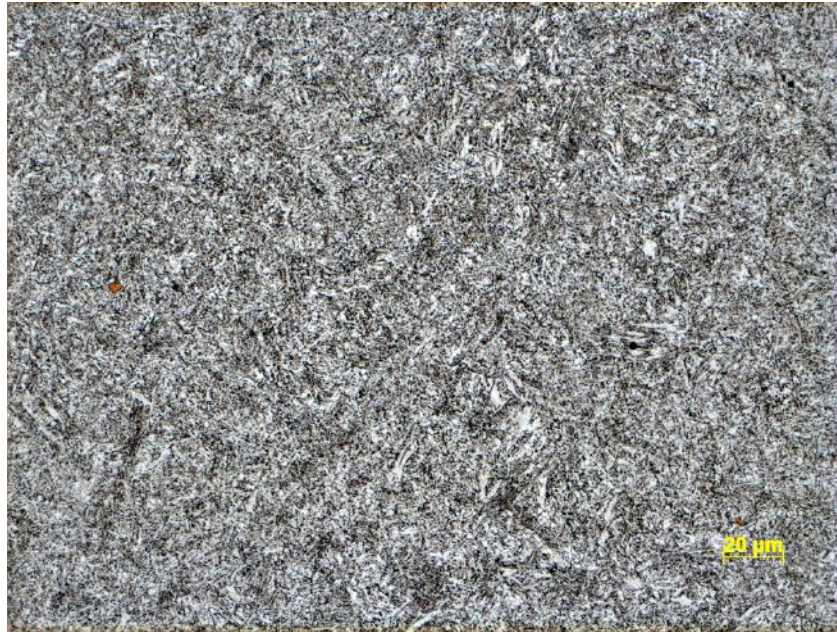
Figura 38 – Microestrutura do metal de base da amostra tratada a 695 °C por 3 horas (CP 5.3).
