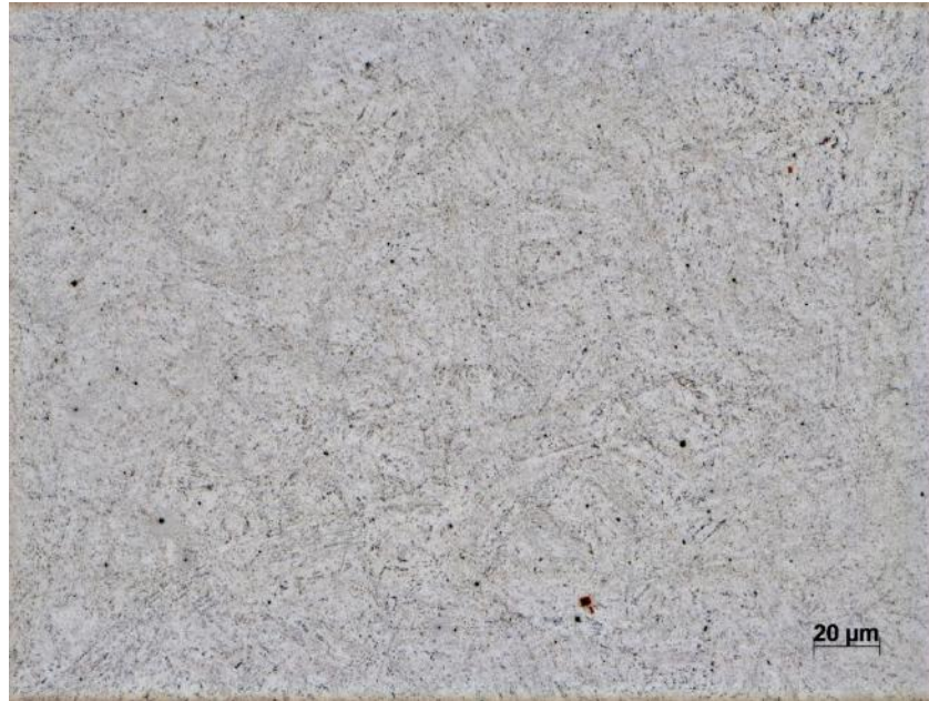
Figura 43 - Microestrutura da amostra tratada a 595 °C por 1 hora (CP 3.1) utilizando o reagente Murakami.
