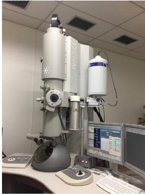
Figura 22 - Microscópio eletrônico de transmissão modelo Tecnai G20.
