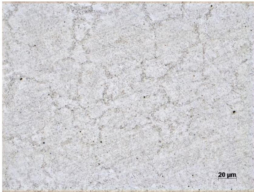
Figura 45 – Região de grãos grosseiros da ZTA da amostra tratada a 595 °C por 1 hora (CP 3.1) que foi revenida por passes posteriores.
