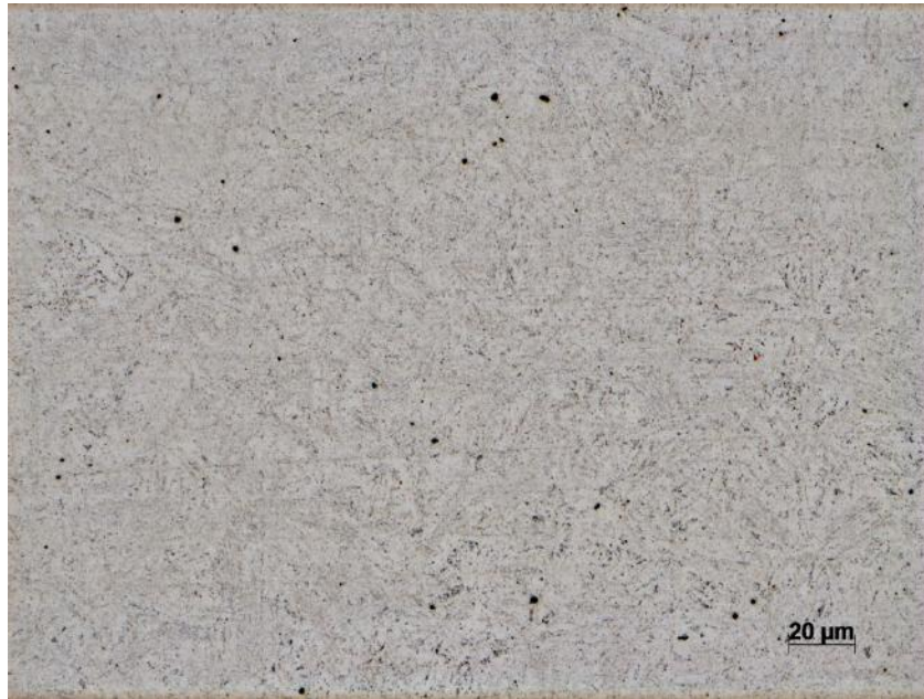
Figura 41 – Microestrutura da amostra sem tratamento térmico utilizando o reagente Murakami.
