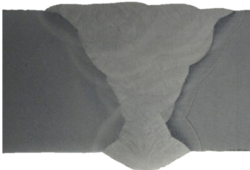
Figura 27 – Macrografia da amostra tratada a 595 °C por 1 hora (CP 3.1).
