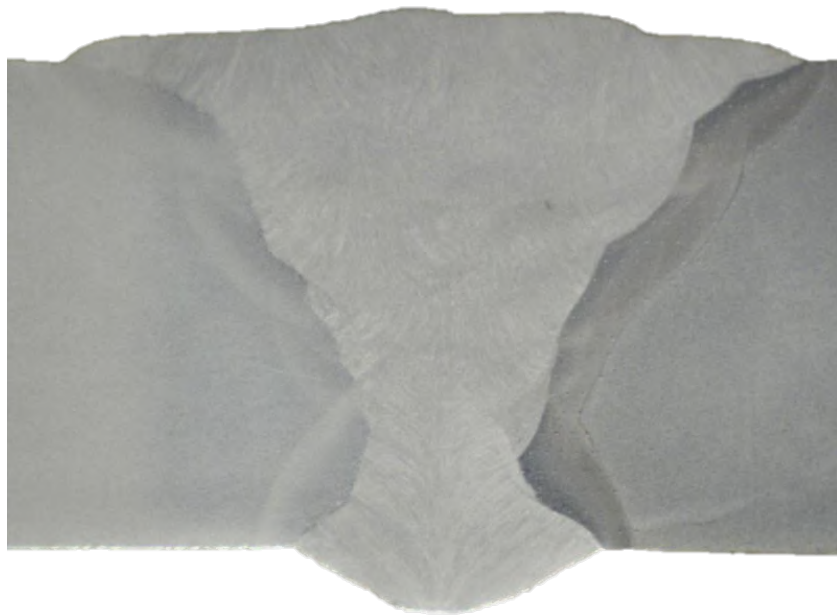
Figura 23 – Macrografia da amostra sem tratamento térmico (CP 0.0).
