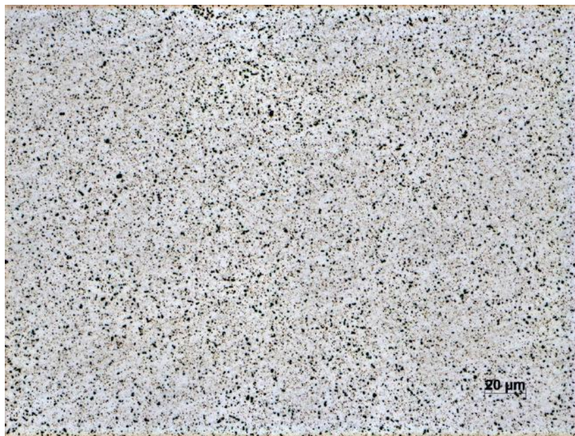
Figura 47 - Região de grãos finos da ZTA da amostra tratada a 695 °C por 3 horas (CP 5.3).
