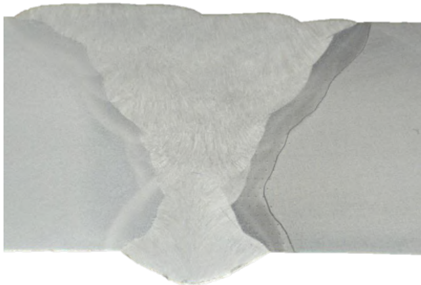
Figura 64 - Macrografia da amostra 1.2.
