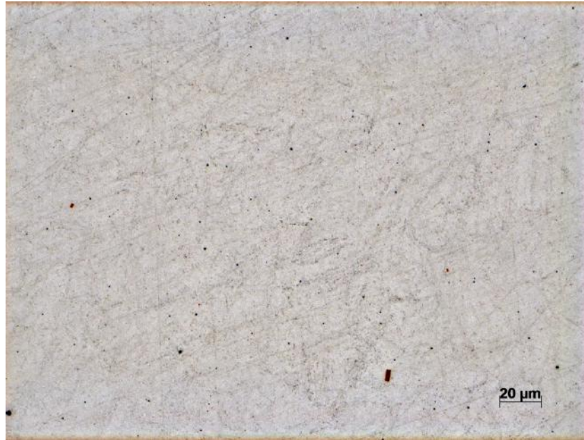
Figura 51 - Região de maior dureza da amostra tratada a 595 °C por 1 hora (CP 3.1) atacada com o reagente Groesbeck.
