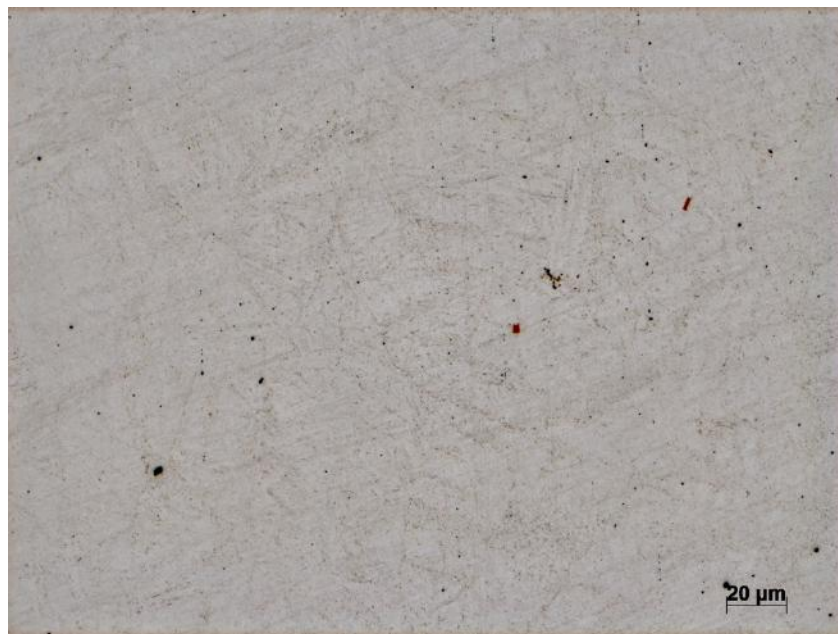
Figura 50 – Região de maior dureza da amostra tratada a 495 °C por 1 hora (CP 1.1) atacada com o reagente Groesbeck
