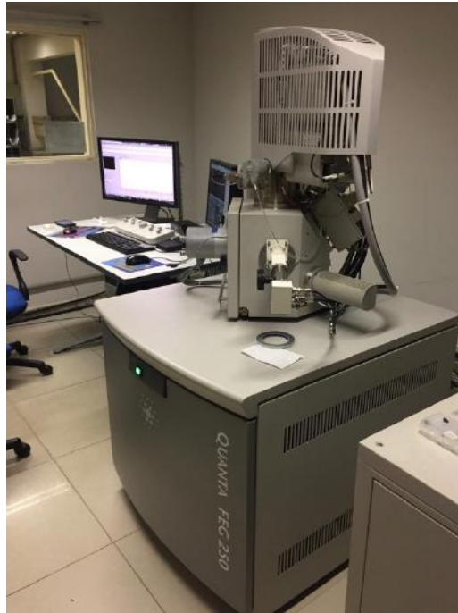
Figura 21 - Microscópio eletrônico de varredura modelo Quanta FEG 250.
