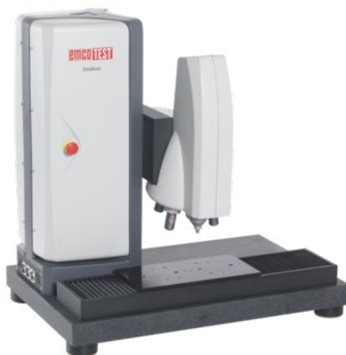
Figura 19 - Durômetro utilizado para os ensaios de dureza.
