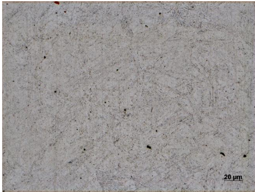
Figura 42 - Microestrutura da amostra tratada a 495 °C por 1 hora (CP 1.1) utilizando o reagente Murakami.
