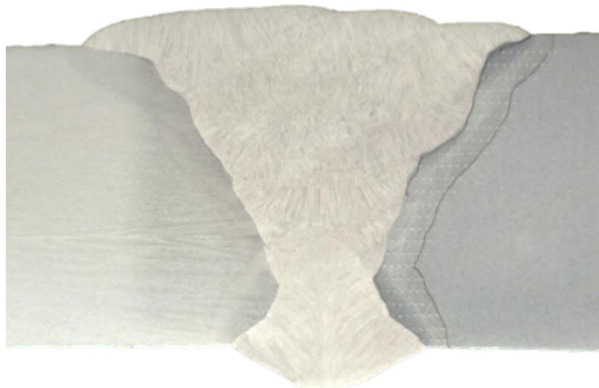
Figura 29 – Macrografia da amostra tratada a 695 °C por 3 horas (CP 5.3).
