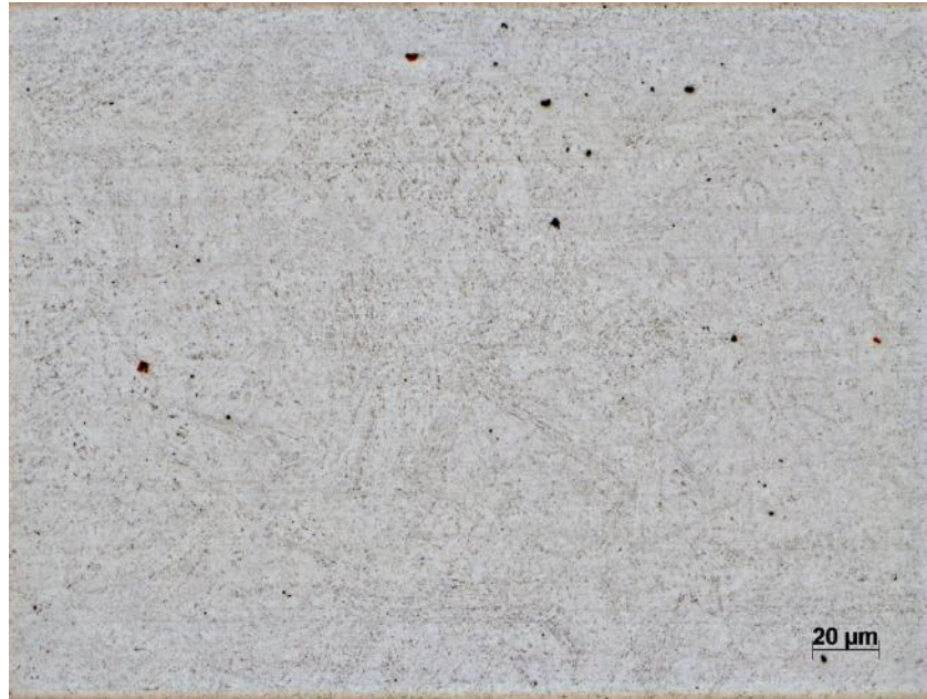
Figura 49 - Região de maior dureza da amostra CP sem tratamento térmico atacada com o reagente Groesbeck
