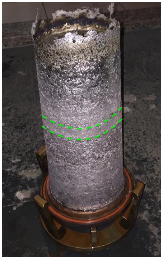
Figura 4-1 - Lingote obtido pela fusão no forno VAR-COPPE.
