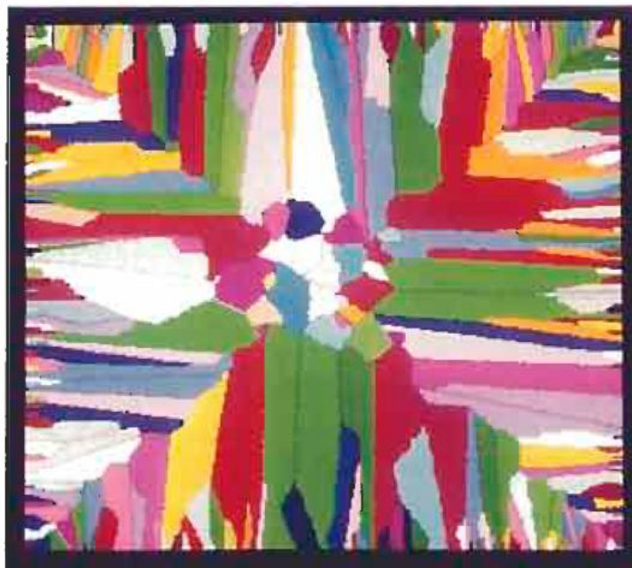
Figura 2-12 - Microestrutura bruta de solidificação de um lingote vista do topo [20].
