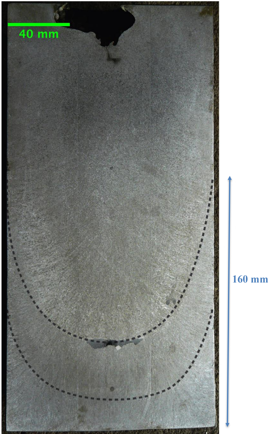
Figura 4-3 - Macrografia da seção transversal do lingote fundido no forno VAR-COPPE.
