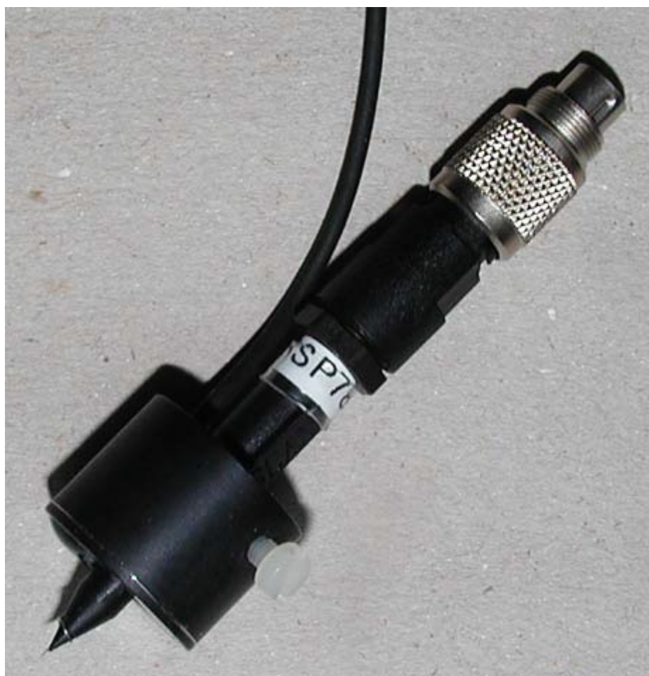
Figura 3.4: Sonda com eletrodo de referência e contra eletrodo acoplado.
