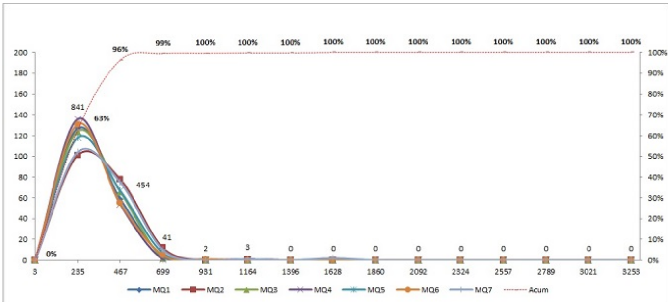
Figura 4.7: Distribuição das medições de resistividade ponto a ponto para aço martensítico M (13Cr).
