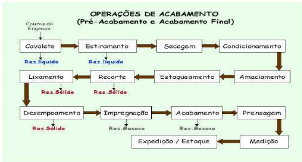
Figura 1.2 - Fluxograma esquemático da fabricação de couros - operações de acabamento / Fonte: CETESB
