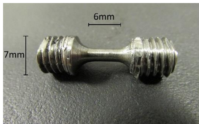
Figura 9 - Corpo de prova usinado a partir de um anel de vedação para ensaio de tração.
