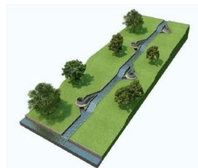
Simulação de combinação de várias turbinas em um mesmo curso d'água Fonte: Turbulent
