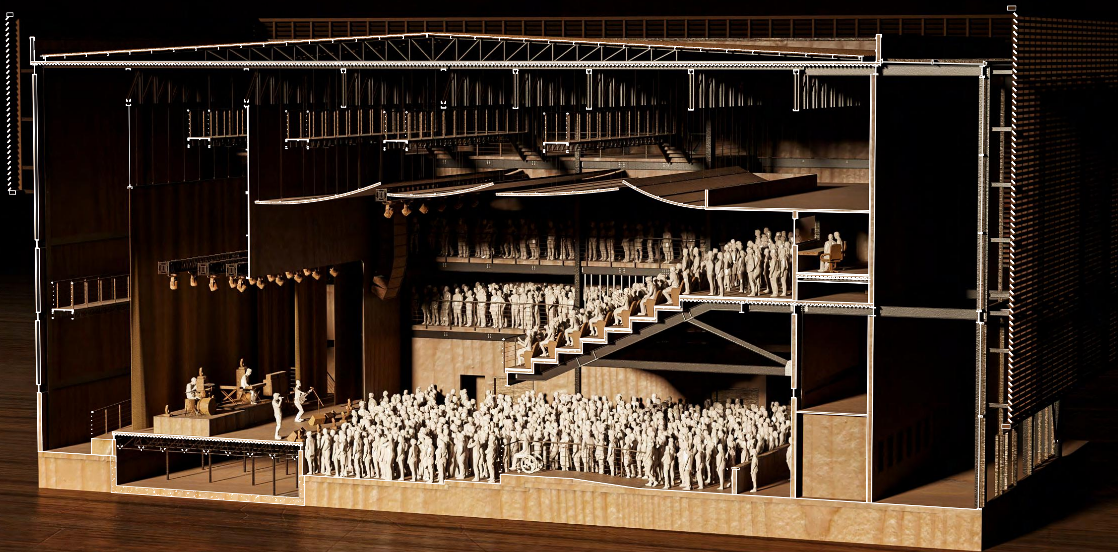
CORTE BB - PALCO, ARQUIBANCADA E ÁREA TÉCNICA
