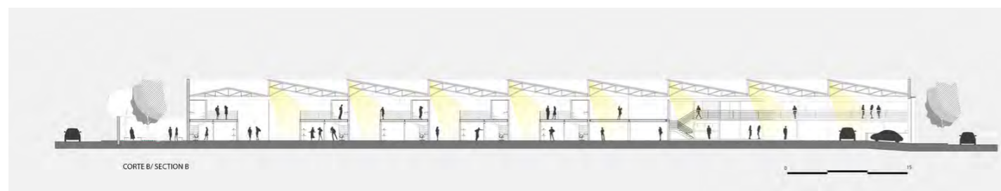
Figura 29: Corte longitudinal. Iluminação zenital demarcada em amarelo. Fonte: Archdaily
