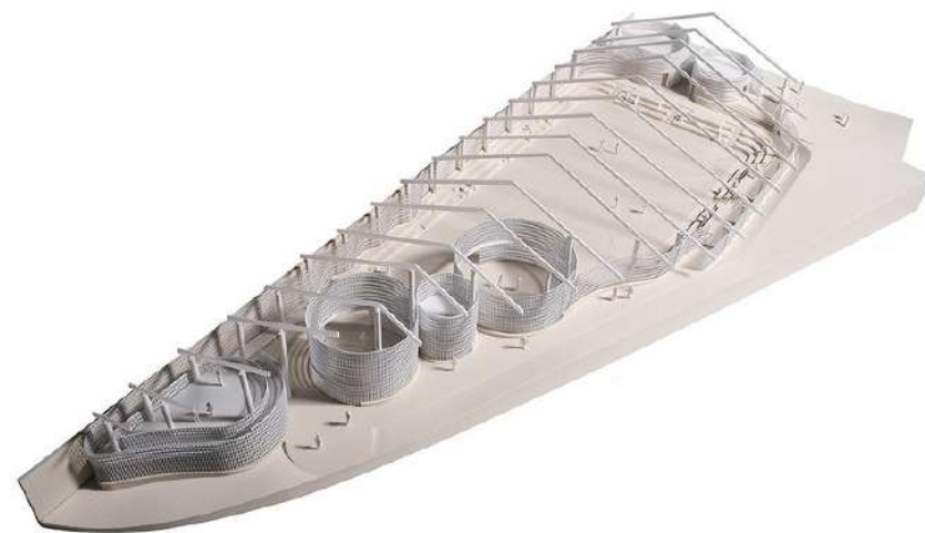
Fig. maquete do ginásio, mostrando a relação entre os volumes internos e a cobertura
