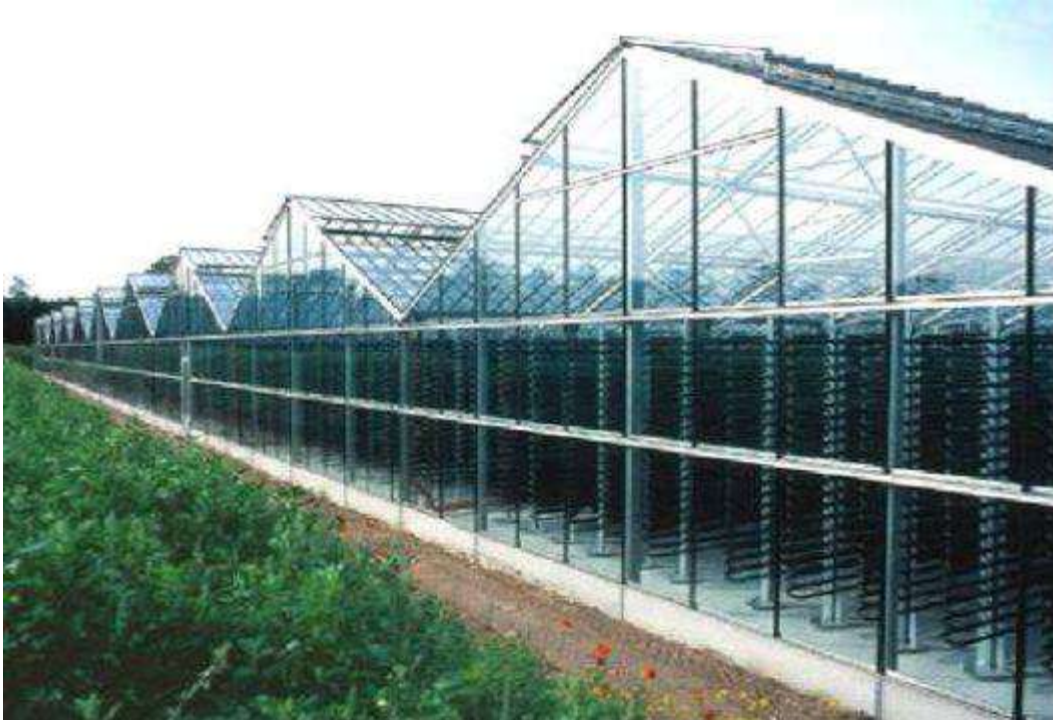
Fig. 2.11 – Sistema fechado – Fotobioreator / Alemanha – produção comercial de algas (140 t/ano) volume: 700 m 3 e área: 1ha Fonte: TEIXEIRA et al., 2008.
