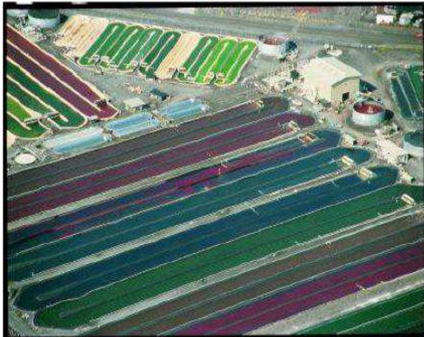
Fig. 2.10 – Sistema de tanque aberto / Cyanotech (Hawaii) – Grande produtor de Spirulina (350 t/ano) Área 10 ha / volume 41.000 m 3 . Fonte: TEIXEIRA et al., 2008.
