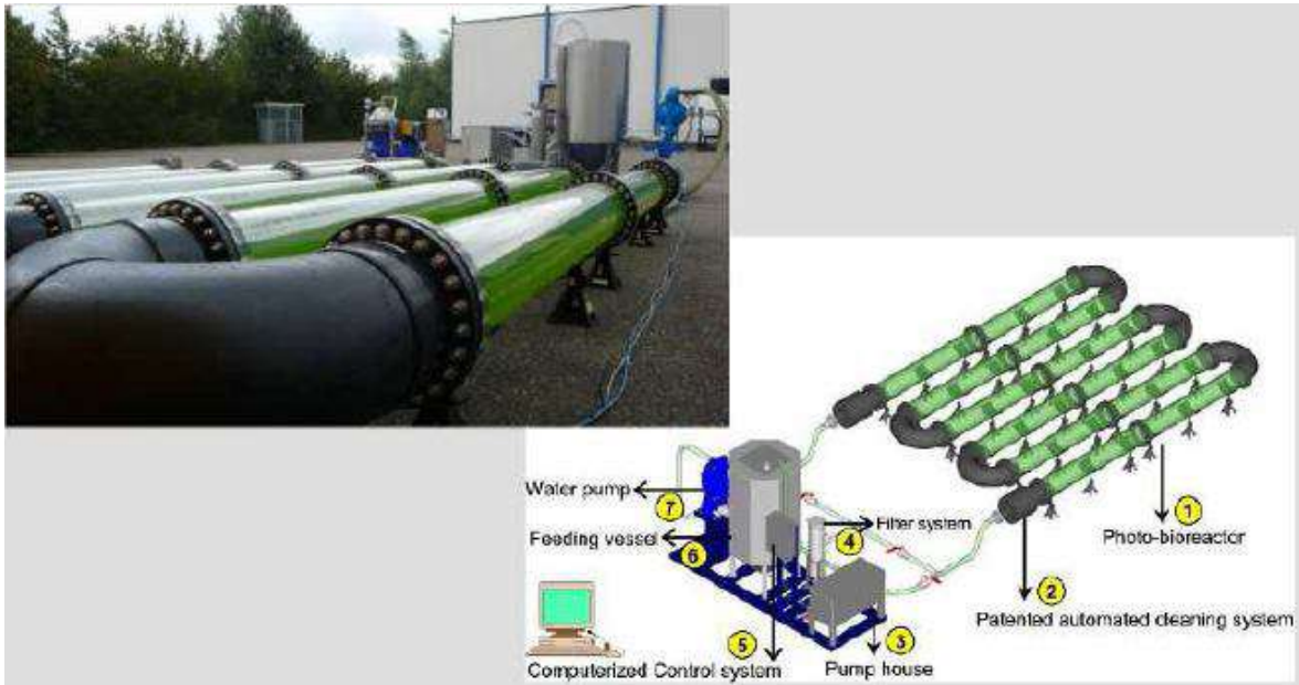
Fig. 2.13 – Sistema de Fotobioreatores tubulares (fechado) para a produção de microalgas. Fonte: TEIXEIRA et al., 2008
