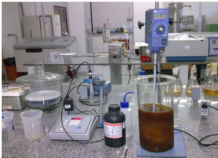
Figura IV.3: Sistema utilizado para ajuste do pH do hidrolisado ácido
