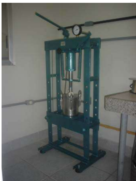
Figura IV.2: Reator acoplado em prensa hidráulica
