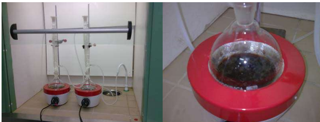
Figura IV.12: Sistema reacional utilizado no processo organosolv
