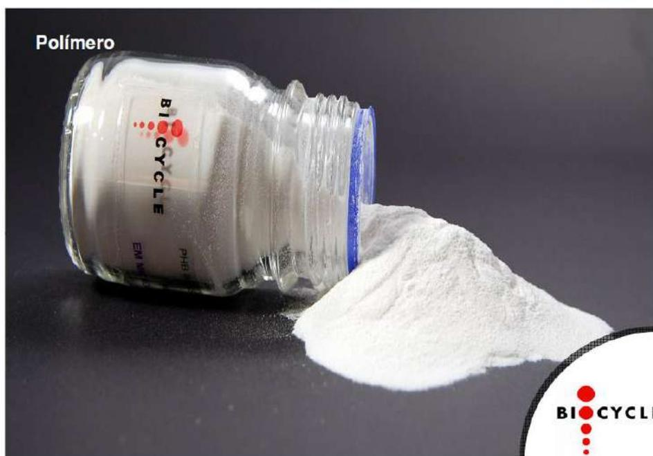
FIGURA 11 – PHB OBTIDO EM FORMA DE PÓ AO FINAL DO PROCESSO DE SECAGEM, PELA EMPRESA BIOCYCLE® (FONTE: [HTTP://WWW.BIOCYCLE.COM.BR/](http://www.biocycle.com.br/))
