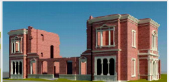
**^ Figs. 8 a 10:** Vistas renderizadas da edificação. O modelo HBIM das ruínas foi gerado a partir dos dados obtidos por escaneamento a laser. "Todo o ciclo de vida do bem pode ser capturado no modelo, por exemplo, defeitos estruturais atuais, material características, relatórios de inspeção atualizados, informação legada, fotografias, esboços, desenhos, propostas futuras e atas de reuniões podem ser ligados a características e áreas específicas." Historic England.
