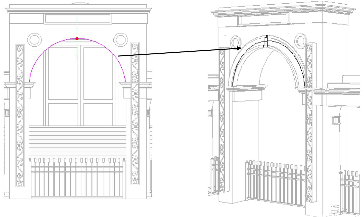
Processo de modelagem do arco do Portão da Coroa a partir da ferramenta de varredura de perfil, do Revit 2019.
