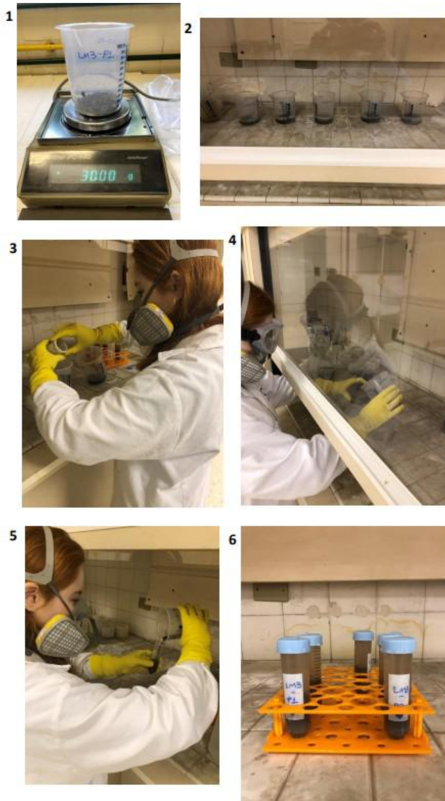
Figura 16: 1) Amostra sendo pesada; 2) Amostras com Fluoclor; 3) Processo de lavagem do líquido sobrenadante com peneira de abertura 10 \mu m mesh; 4) Processo de filtragem na peneira de abertura 200 \mu m mesh; 5) Transferência do resíduo de cada amostra para o tubo Falcon de 50 ml; 6) Amostras com ZnCl 2 .
