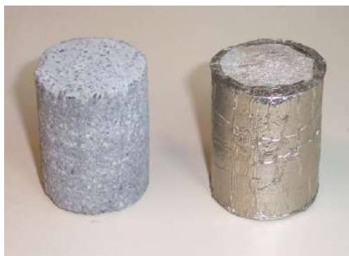
Figura 3-4 Plugue consolidado (à esquerda) e plugue encapsulado (à direita)
