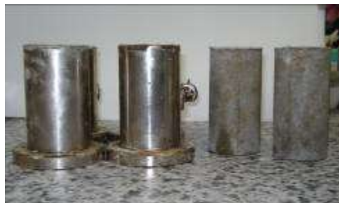
Figura 2.2: Corpos de prova moldados
