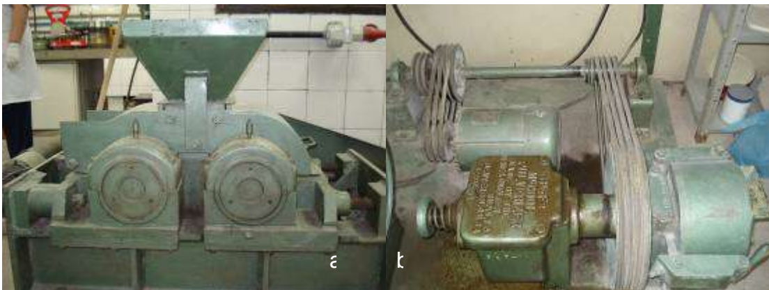
Figura 2.1: (a) Triturador de rolos (b) Pulverizador DENVER
