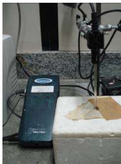
Figura 2.4: (a) Aparelho LabPro (b) Sistema Termopar e LabPro
