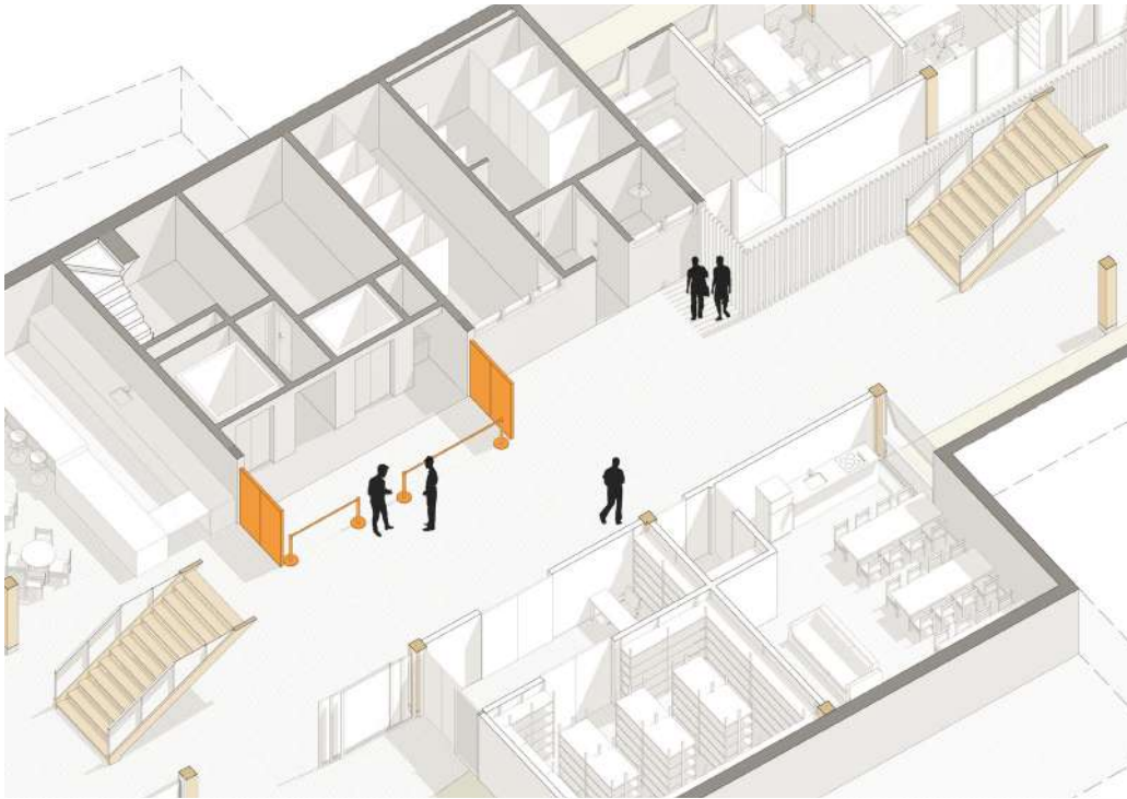
Controle de acesso para pavimentos superiores e transição para espaços restritos
