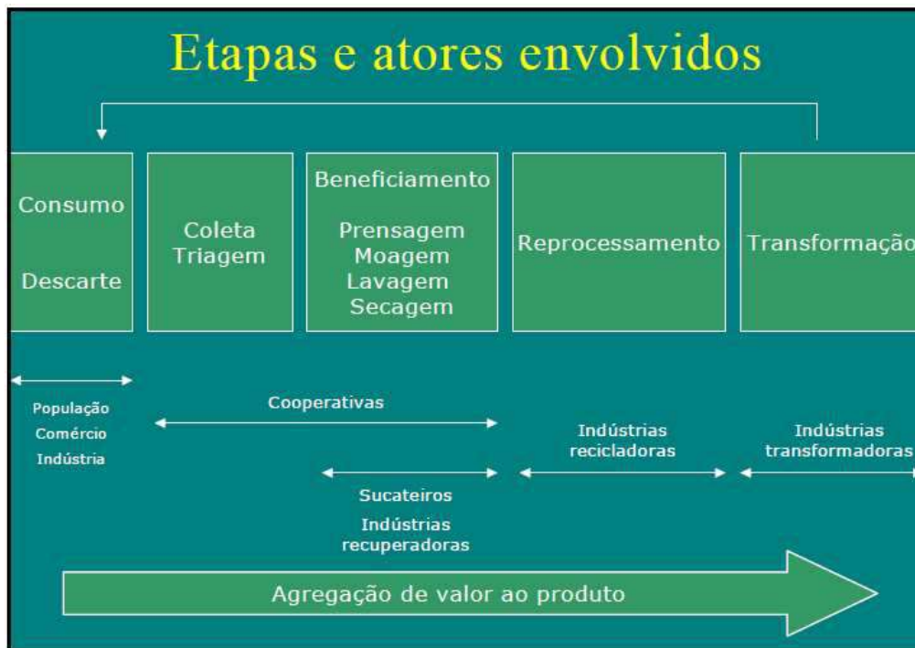
Figura VI.1: Etapas e atores envolvidos na cadeia produtiva da reciclagem de RSU plásticos (ZANIN e colaboradores, 2005).
