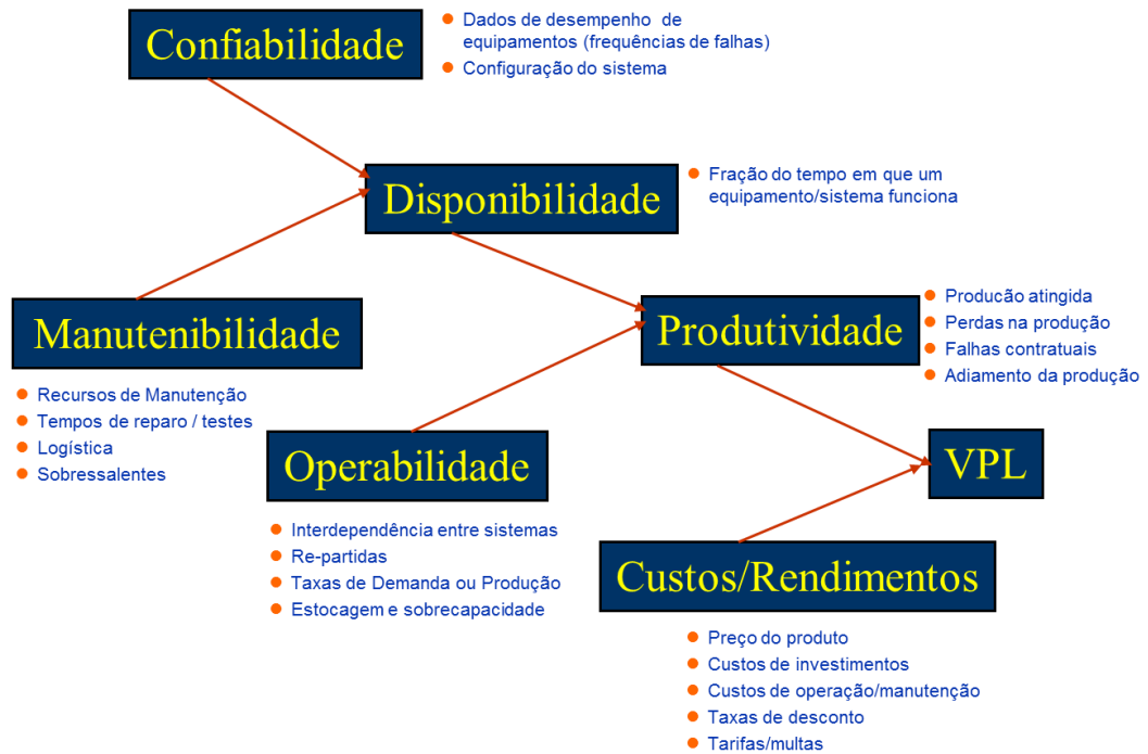
Figura 9 – Esquemático de Entradas e Saídas do MAROS
