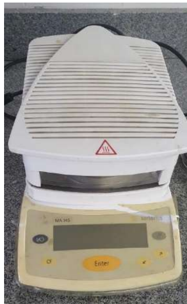
Figura 10. Analisador de umidade da marca Sartorius.
