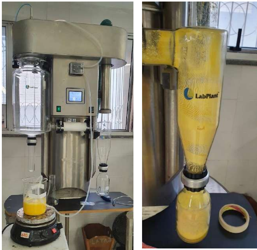
Figura 9. Spray Dryer de escala laboratorial da marca LabPlant.
