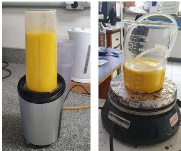
Figura 8. Emulsão preparada no homogeneizador de bancada (à esquerda) e emulsão no recipiente de alimentação do spray dryer (à direita).
