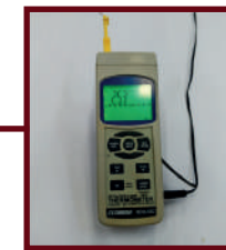
Figura 25: Sistema de Aquisição de Dados: Datalogger.
