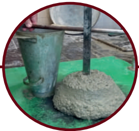
Figura 16: Ensaio de abatimento do tronco de cone.
