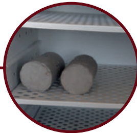
Figura 17: Corpo de prova em estufa antes de ser feito o ensaio de massa específica.
