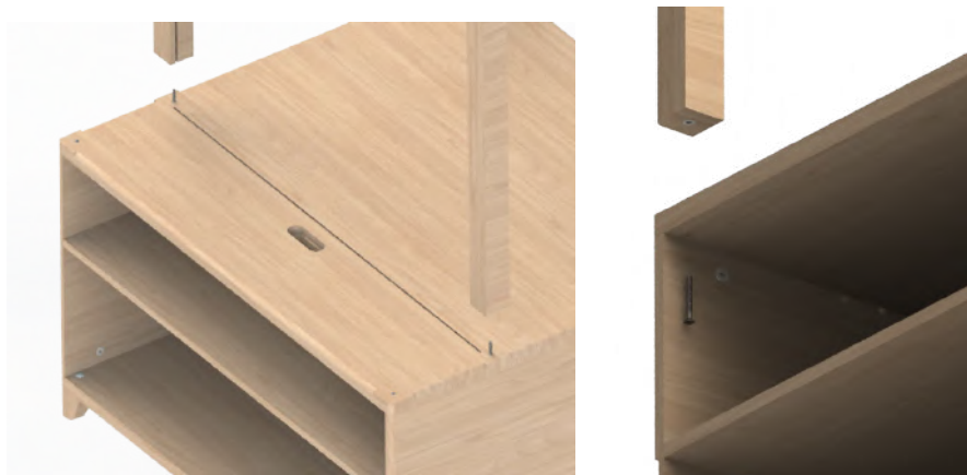
Figura 57: Elementos industriais de fixação das travessas verticais na base do mobiliário Be
