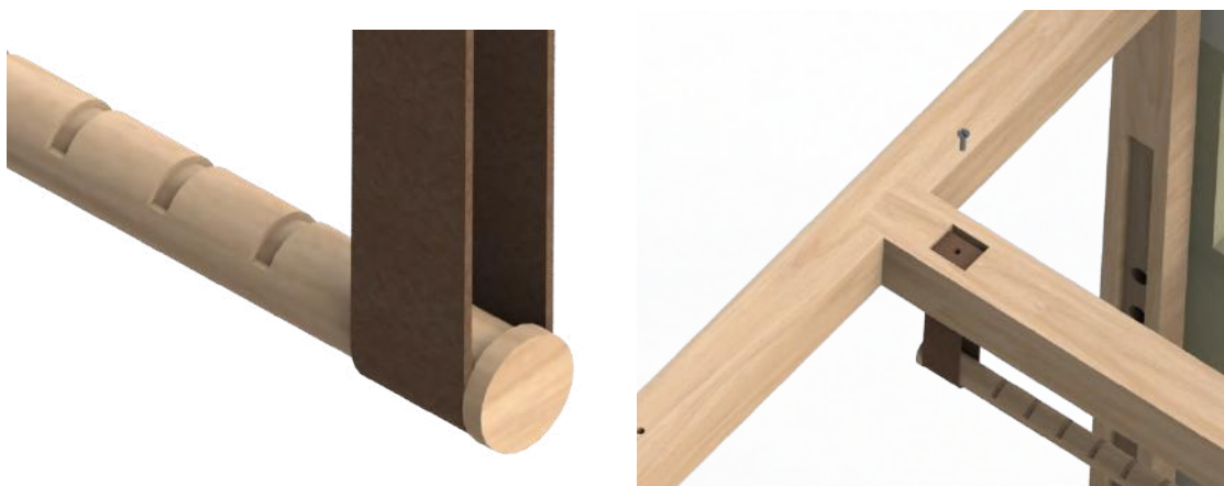
Figura 64: Cabideiro com rebaiços para o encaixe de cabides e fixação do suporte.
