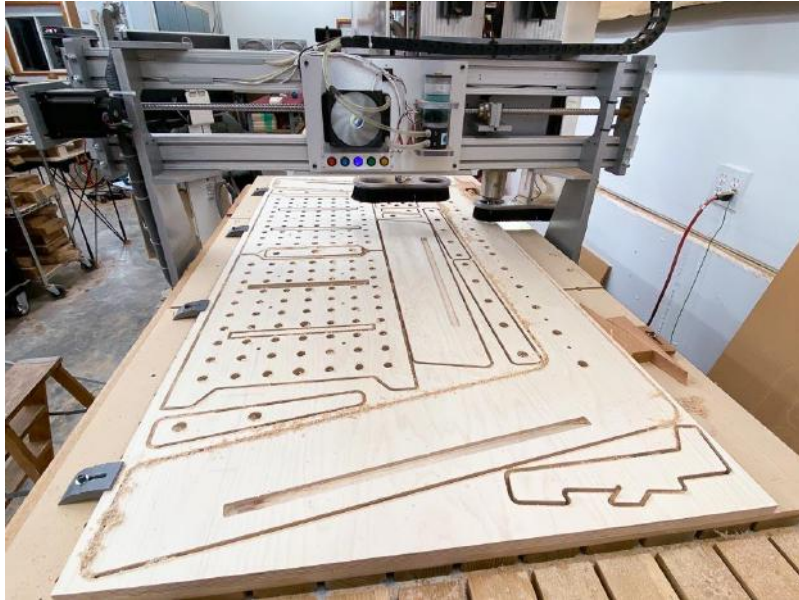
Figura 83: Usinagem Router CNC. Fonte: Popular Woodworking, 2021.
