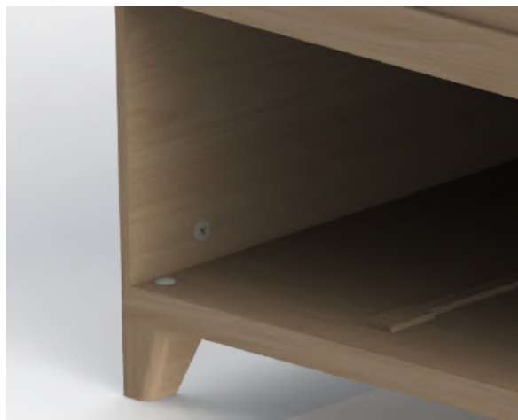
Figura 56: Elementos industriais de fixação na base do mobiliário Be.
