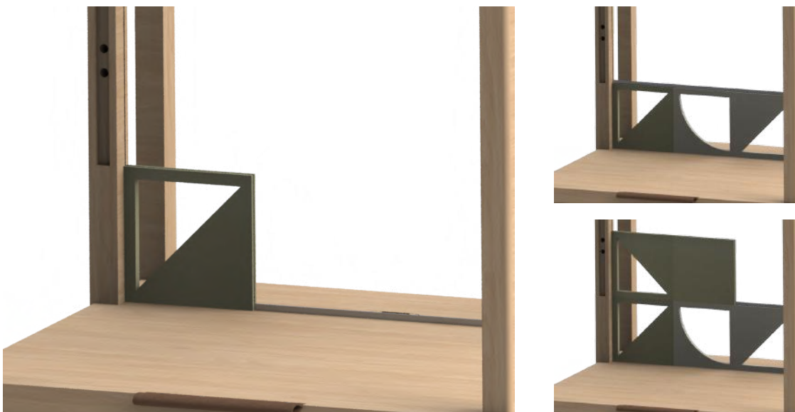
Figura 55: Encaixe dos azulejos nas traves de alumínio.
