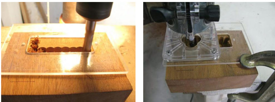
Figura 91: Desgaste com furadeira de coluna e acabamento por tupia, com gabarito.
