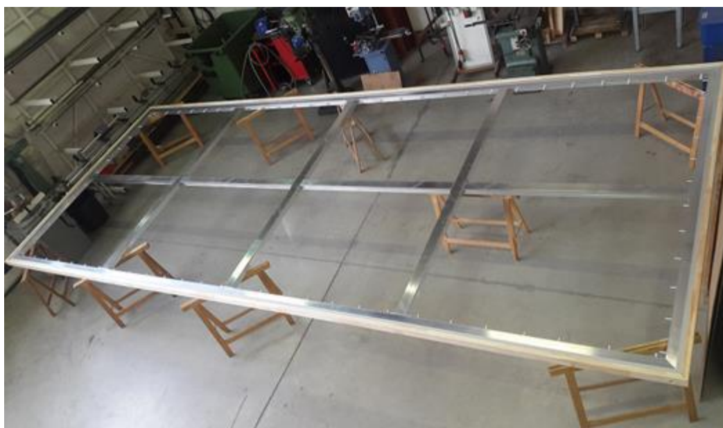
Figura 18: Chassi de alumínio, para grandes formatos
