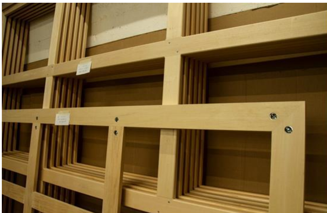
Figura 17: Chassis de madeira com mecanismo tensor rosqueado
