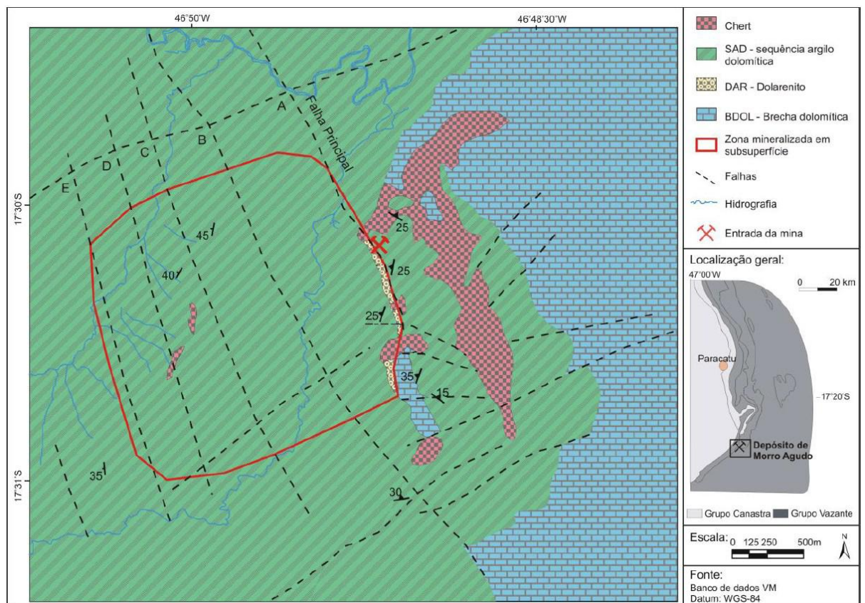
Figura 15 - Mapa geológico local, representando unidades aflorantes em superfície e disposição de falhas inferidas da mina de Morro Agudo, que subdivide o depósito em blocos A, B, C, D, E e F (ausente no mapa). Extraído de Neves, 2011.
