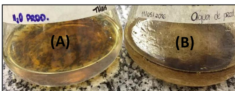
Figura 18: Visualização do crescimento de microrganismos presentes na água de recuperação de petróleo tendo óleo bruto como única fonte de carbono: teste controle sem adição de água do petróleo (A) e com adição da água após 5 dias de incubação (B).
