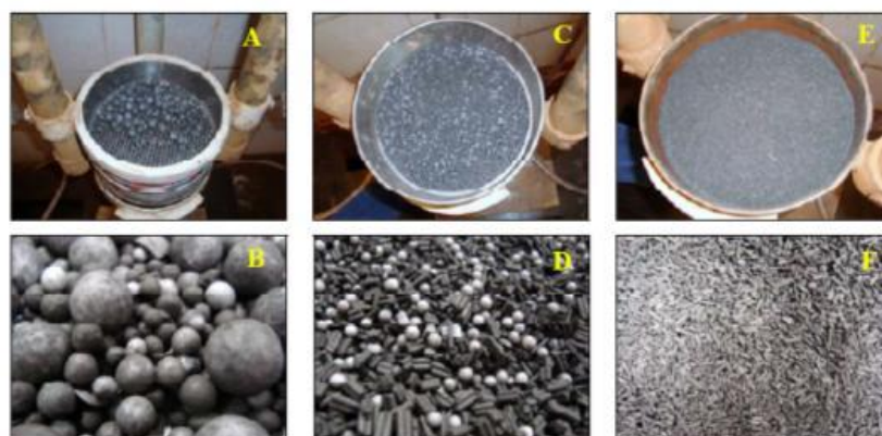
Figura 15: Aspecto macroscópico das diferentes frações do catalisador (A e B: fração >6 mesh; C e D: 10 < fração < 6 mesh; E e F: fração < 10 mesh).
