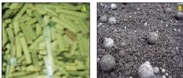
Figura 13: Partículas constituintes do catalisador: (A) antes e (B) após seu uso na unidade de HDT.
