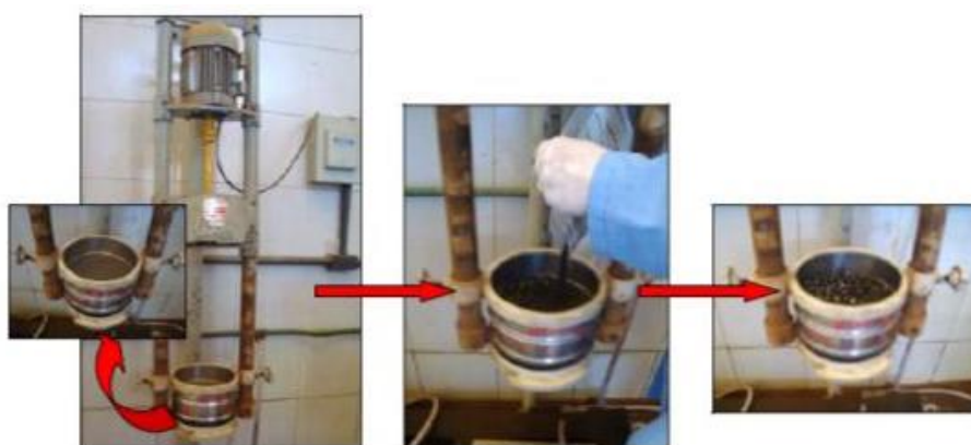
Figura 14: Equipamento e etapas necessárias para separação do catalisador esgotado da amostra procedente da refinaria.
