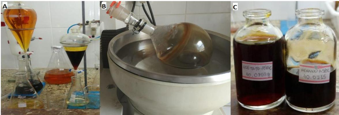
Figura 15: A - Partição dos extratos brutos. B - Obtenção das frações em evaporador rotativo. C - Fração em acetato e fração em hexano.
