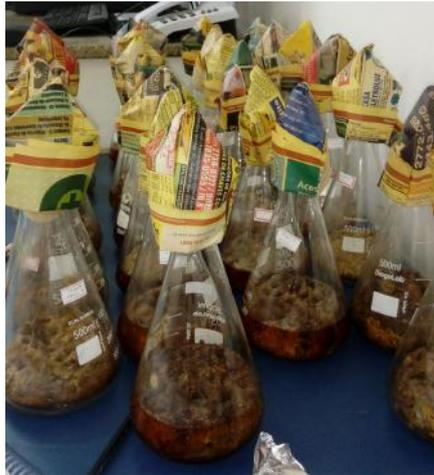
Figura 14: Processo de maceração dos metabólitos com etanol.
