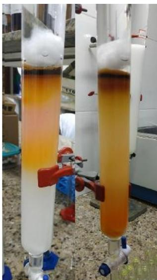
Figura 17: Cromatografia em fase normal da fração em acetato de etila.
