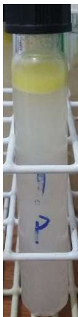
Figura 5-10 Separação completa da mistura d-limoneno e Aliquota 0
