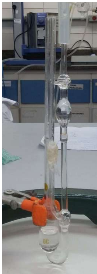
Figura 5-2 Viscosímetro utilizado para determinação das viscosidades
