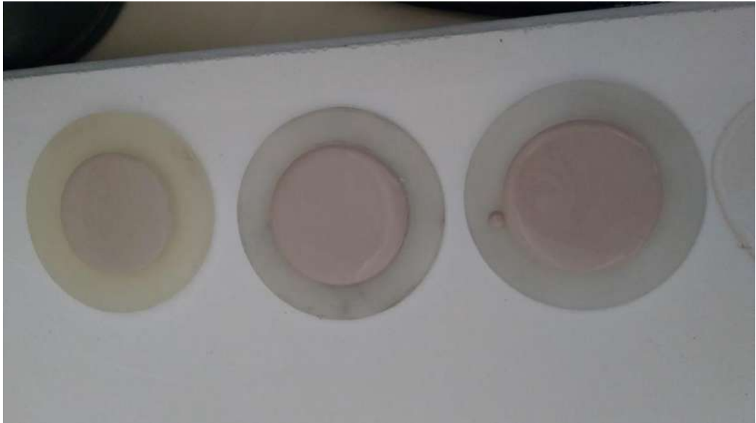
Figura 12– Conformação Realizada com a Dispersão sendo Preparada no Moinho de Bolas Cerâmicas, por 48 horas.
