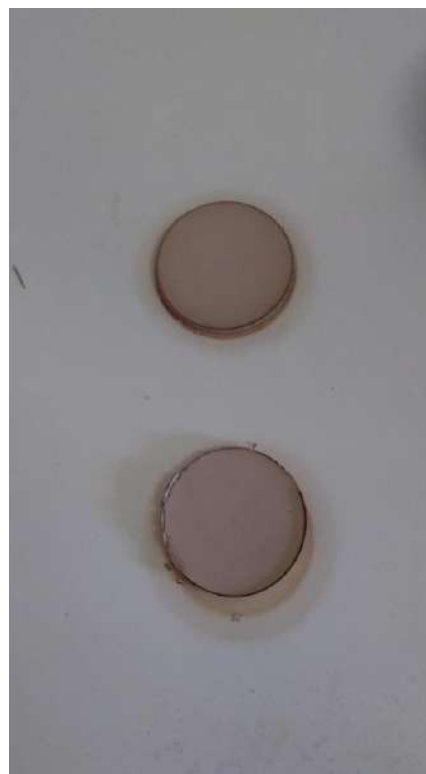
Figura 13 - Corpo Verde Após 1 Dia de Secagem em Temperatura Ambiente.
