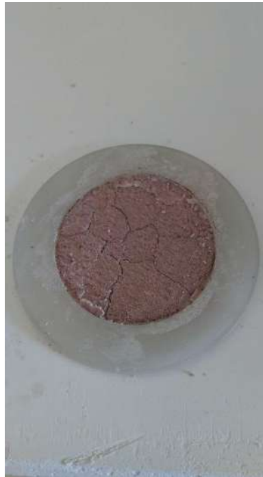
Figura 10 - Conformação Prévia da Membrana Realizada com a Dispersão sendo Preparada Somente com o Dispersor Cowles, por 30 Minutos.
