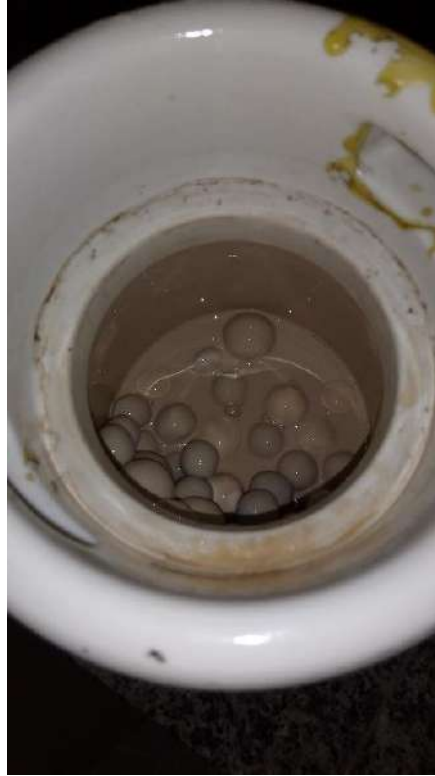
Figura 11 - Melhor Homogeneidade da 1ª Dispersão, Após Moinho de Bolas Cerâmicas por 48 horas.
