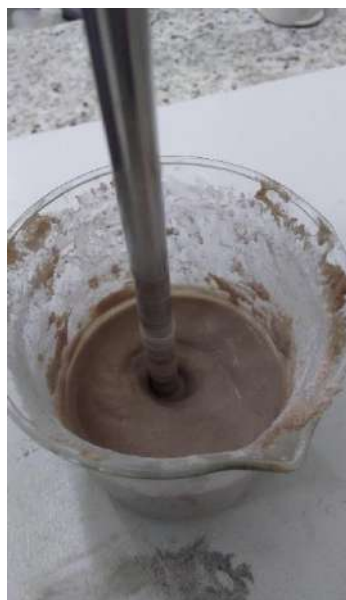
Figura 9 - Preparo da Dispersão Utilizando Dispensor Cowles .
