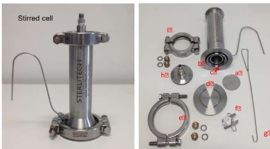
Figura9 Foto da Stirred cell HP4750 (Sterlitech) utilizada nos experimentos de permeação das membranas.
