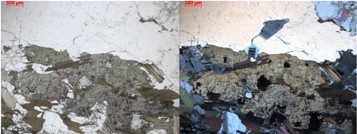
Figura 15 – Na porção inferior da lâmina, um aglomerado de cristais de hornblenda com biotita. À esquerda nicóis descruzados, à direita, cruzados.
