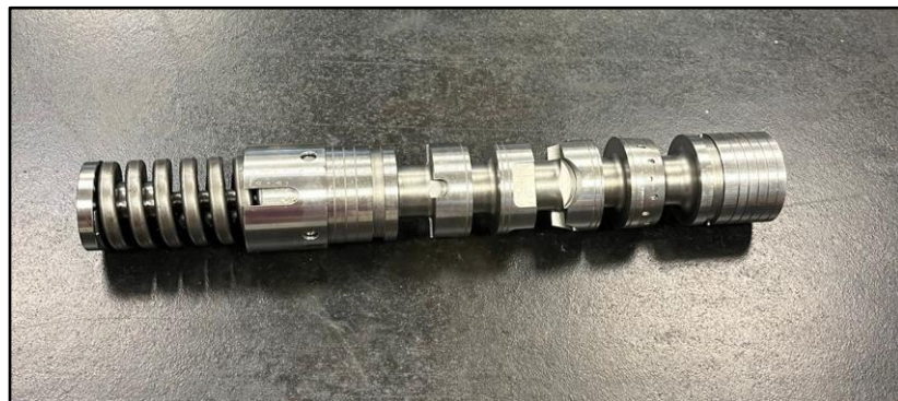
Figura 16 - Êmbolo da MCV de um guindaste
