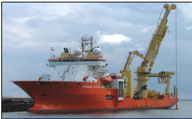
Figura 4 - Guindaste hidráulico telescópico em ação a bordo do Normand Cutter
