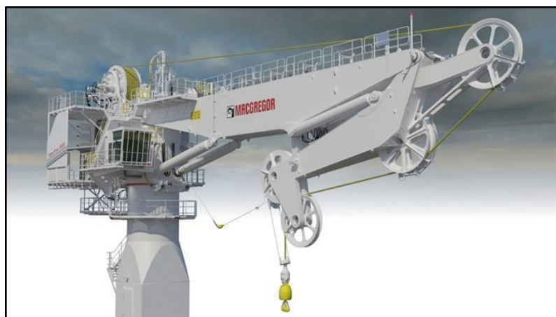
Figura 3 - Desenho 3D de guindaste hidráulico de lança articulada telescópico em ação
