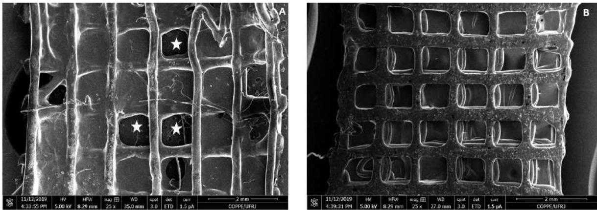
**Figura 5. 6** Na micrografia A se observa o arcabouço de uma visão frontal, as estrelas demonstram pontos onde não se vê hidrogel são pontos de tensão. Na micrografia B se vê o arcabouço de uma visão de fundo, observando sua estruturação de eixo 0-90°.
