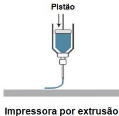
**Figura 3. 7** Desenho esquemático da parte ativa do tipo de bioimpressora que foi utilizada no presente estudo (Imagem adaptada de Gungor-Ozkerim, 2018).
