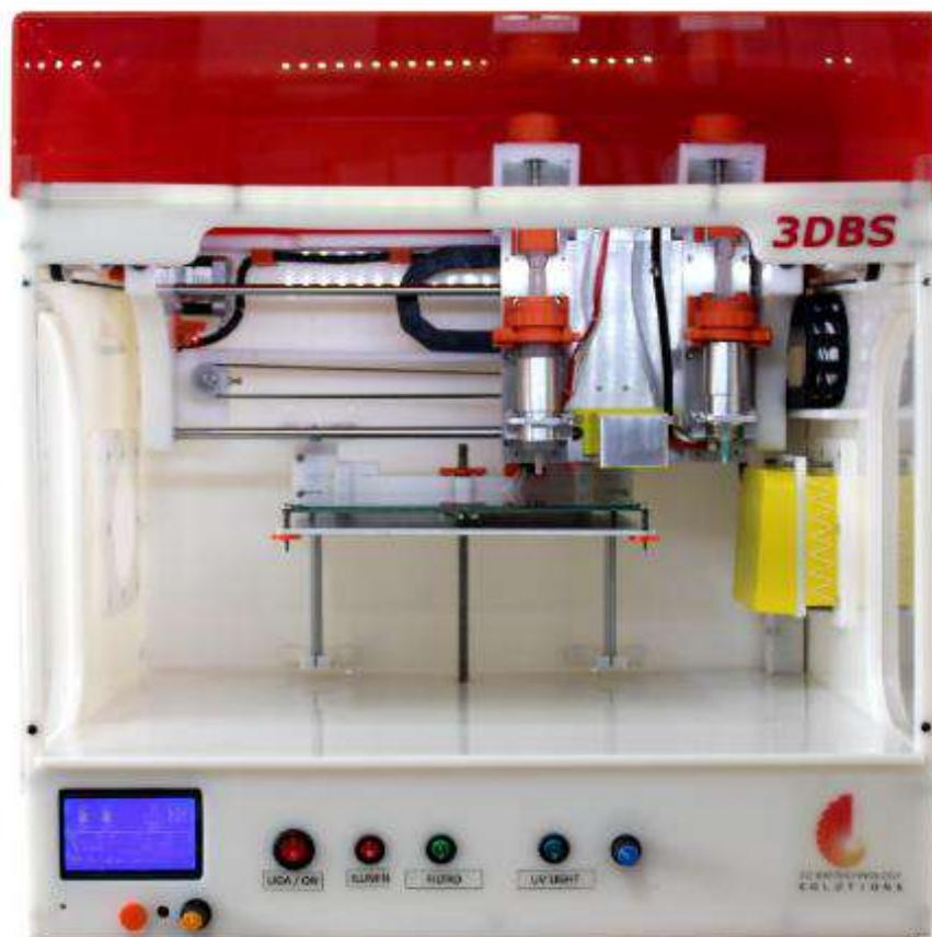
**Figura 4. 9** Foto da bioimpressora Genesis II™ utilizada no presente estudo para realizar a impressão dos arcabouços híbridos.
