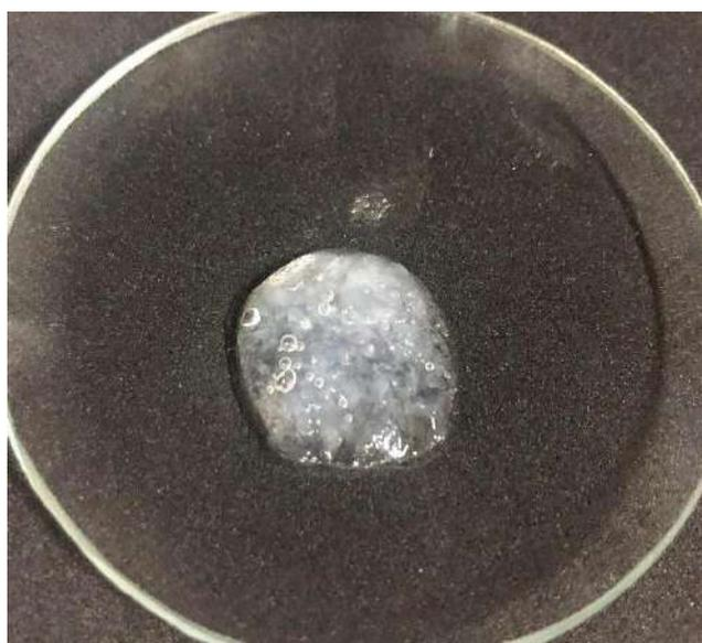
**Figura 4. 6** Aspecto do hidrogel de quitosana e gelatina obtido logo após o processamento
