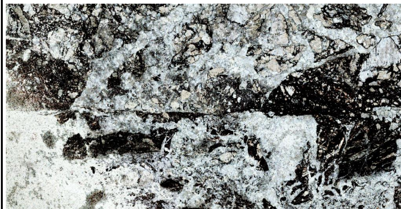
Aproximação da lâmina para ressaltar os grãos de cataclasito compostos de grãos do diorito cimentados por óxido de ferro, além da última ativação presente que falha todos os cristais na rocha, com pouca percolação de óxido de ferro.
