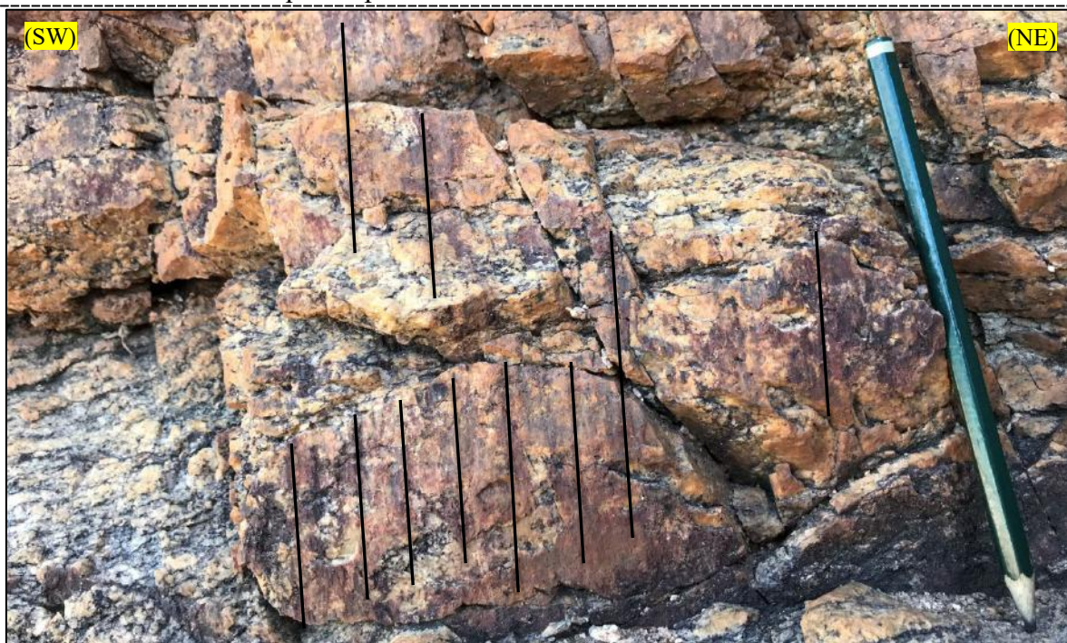
Figura 3.31 – Brecha em falha cataclástica muito bem marcada com orientação de movimento normal oblíquo no ponto TH-33
