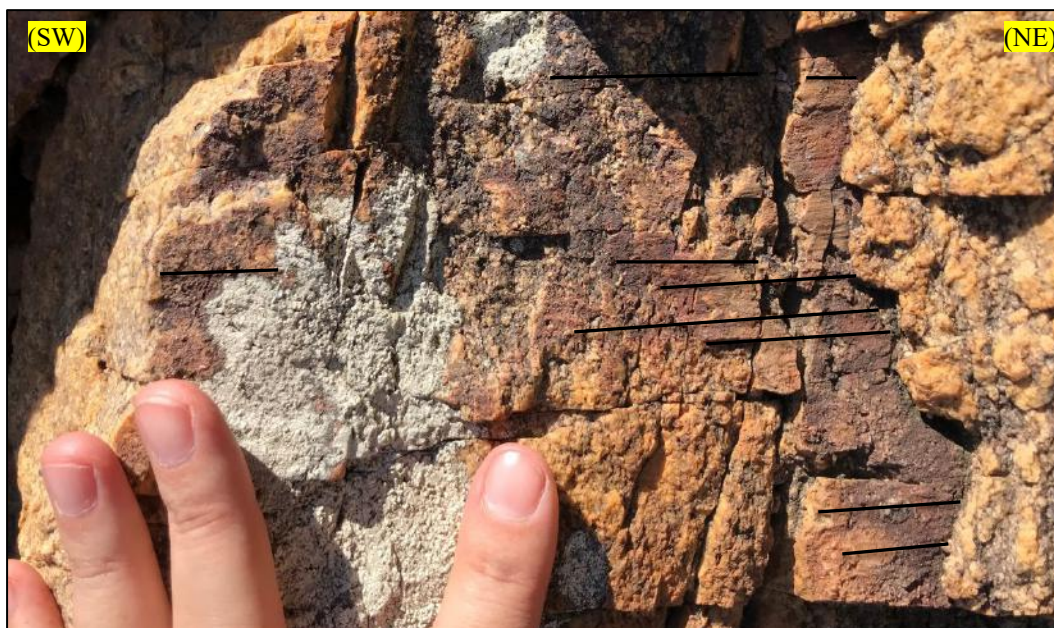
Figura 3.33 – Falha cataclástica com orientação de movimento predominantemente horizontal no ponto TH-33.
