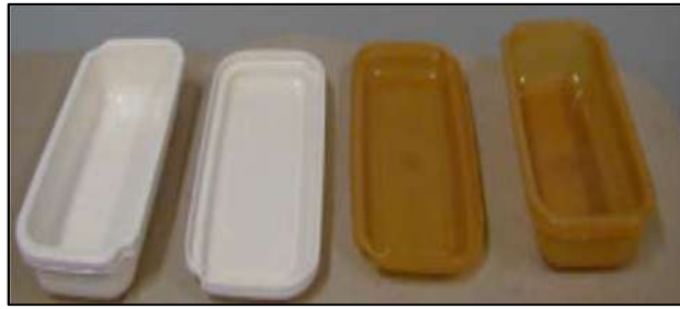
Figura 9. Recipientes Potes produzidos com PHB, com pigmentação (branco) e sem pigmentação (âmbar).
