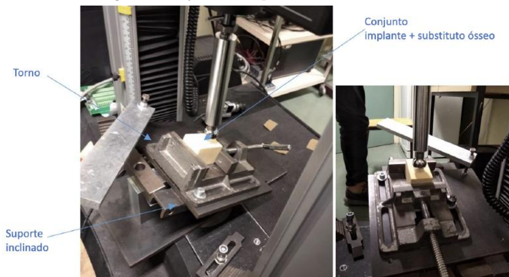
Figura 28: Ajuste final para o ensaio mecânico
