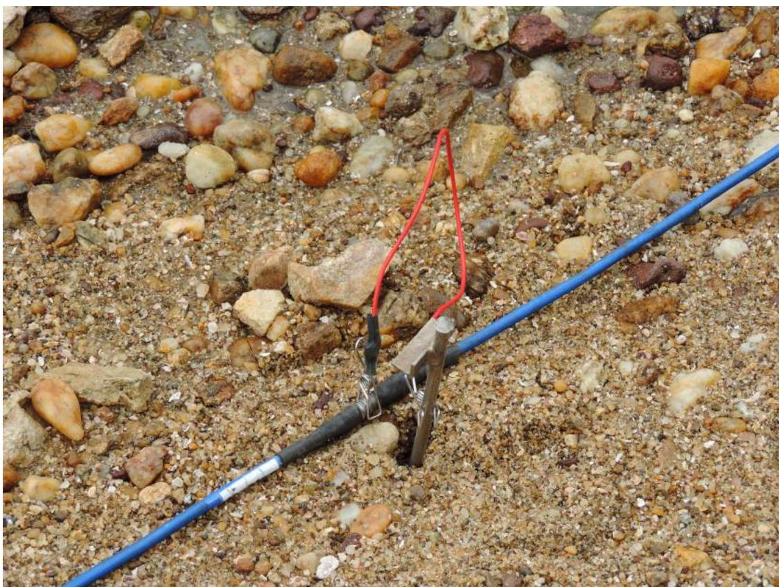
**Figura 24:** Eletrodo, piquete e cabo conector, utilizados na aquisição.
