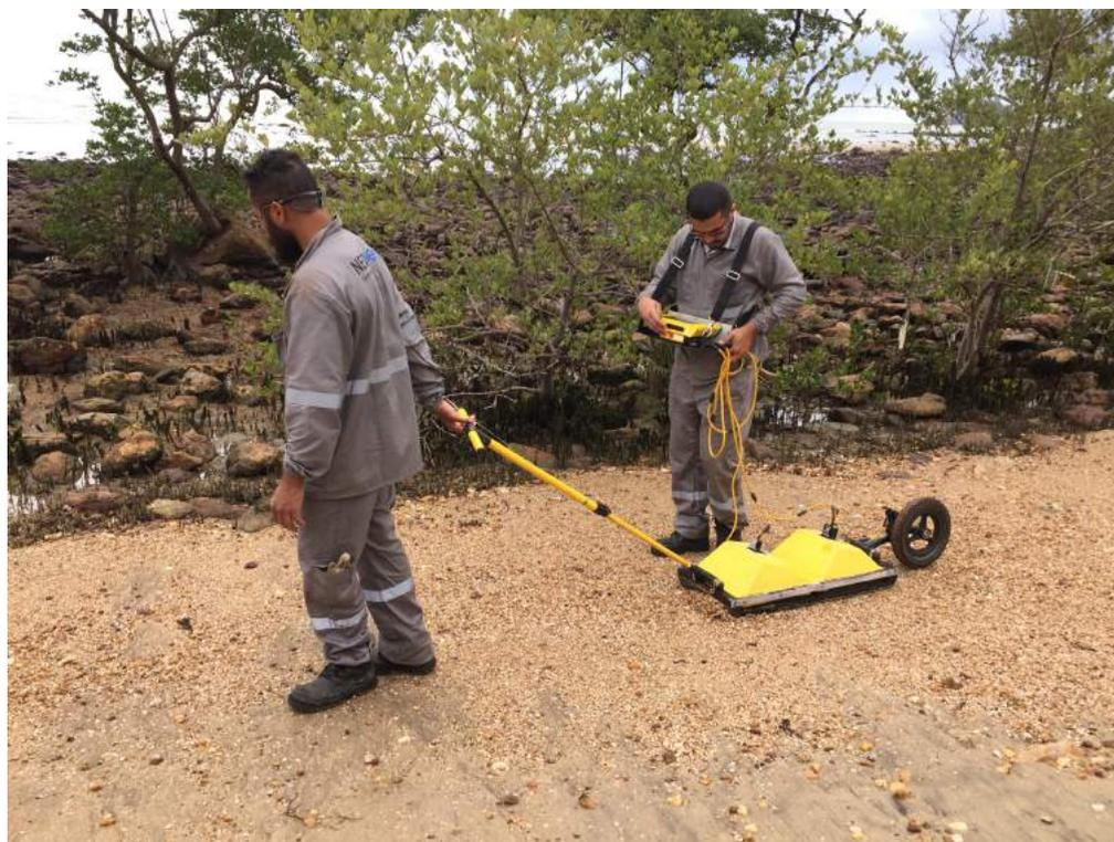
**Figura 20:** Processo de aquisição dos dados, utilizando o GPR.
