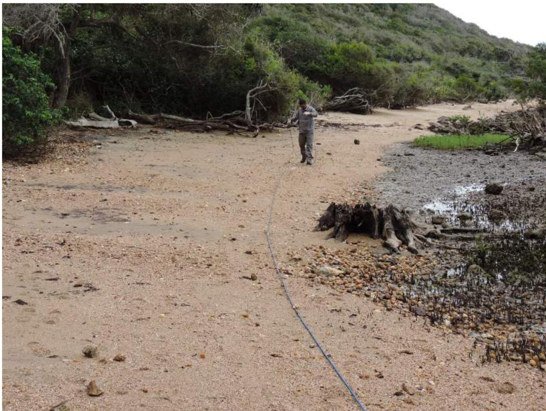
**Figura 23:** Espalhamento dos cabos para a aquisição das linhas elétricas, no Mangue de Pedra.
