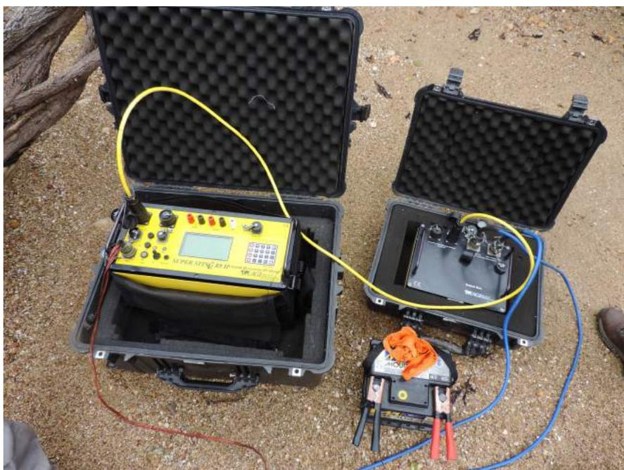
**Figura 22:** Equipamento utilizado no Caminhamento Elétrico realizado no Mangue de Pedra.
