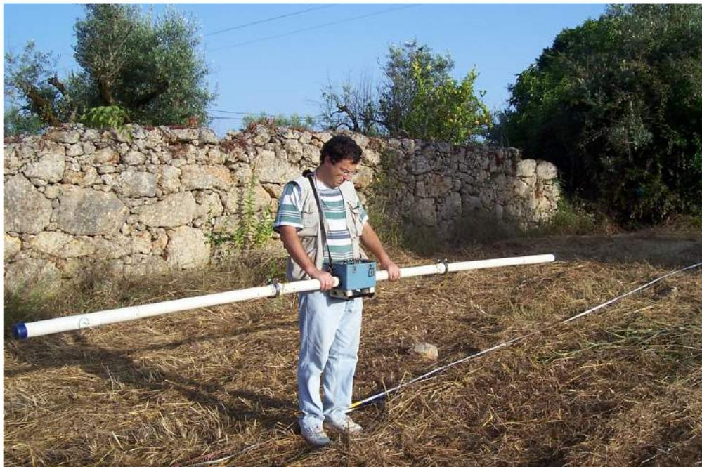
**Figura 16:** Condutivímetro da marca *Geonics*, modelo EM31 (Fonte: Laboratório de Geofísica, Geotecnia e Tratamento de Minérios da Universidade de Coimbra).
