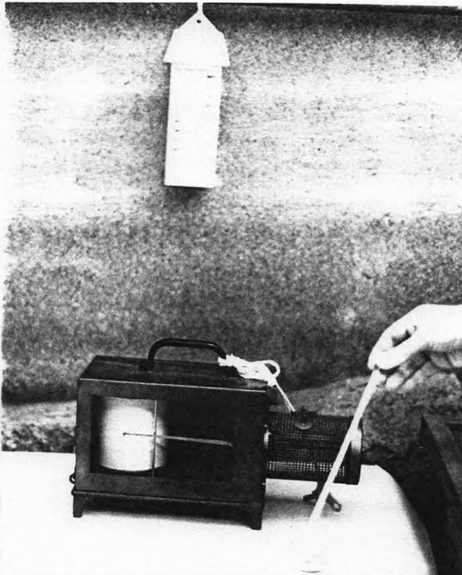
Figura 5 - Registro da temperatura do ar durante as observações cronobiológicas através de um termômetro de máximas e mínimas (em cima) e de um termôgrafo (embaixo). Em primeiro plano, o registro da temperatura da água.
