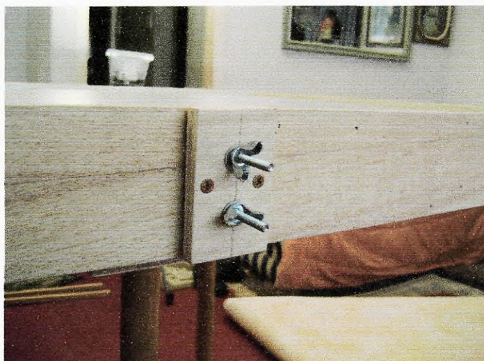
Figura 24 - Sistema de fixação das hastes laterais do aparato de fixação dos sistemas de filmagem e de iluminação.
