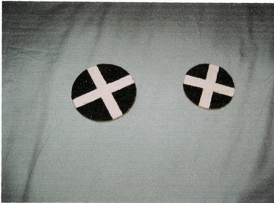
Figura 10 – Discos em madeira compensada de 4 mm. As cruzeiras pintadas sobre os discos permitem uma observação clara de possíveis movimentos rotacionais.
