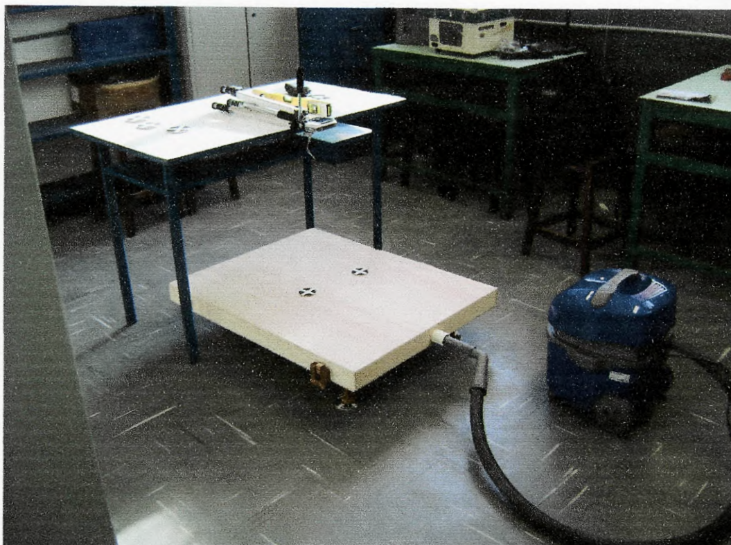
Figura 9 – Vista geral da primeira mesa montada com o aspirador de pó Elettrolux, modelo Flex 1400 que possui as duas funções: aspirar e comprimir.
