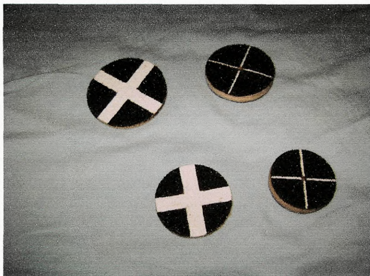
Figura 16 - (a) Discos para colisões com diferentes marcações nos corpos. Os novos modelos, vistos à direita na foto, são feitos em compensado de 10 mm com uma base de poliestireno, muito polido. As cruces mais estreitas permitem uma melhor determinação das coordenadas do disco nas fotos estroboscópicas.
