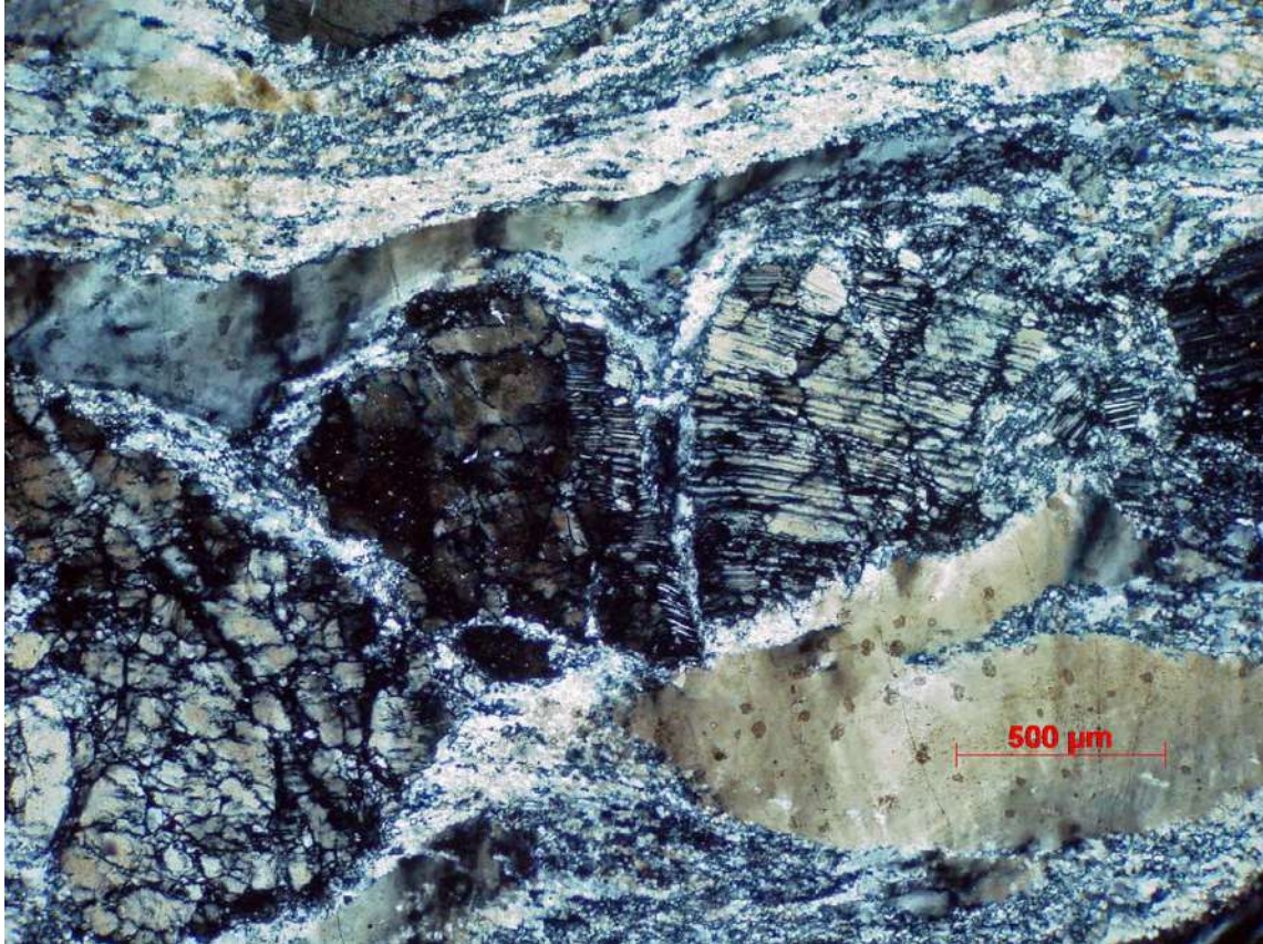
FIGURA 55 – PROCESSO DE BOUDINAGE EM PORFIROCLASTO DE PLAGIOCLASIO COM KINK BANDS E FRATURAMENTO TIPO MOSAICO. ORTOGNAISSE DO COMPLEXO CAMPOS GERAIS. PONTO 29. ORIENTAÇÃO: E-W.
