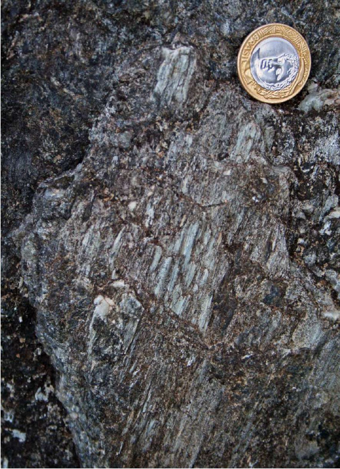
FIGURA 40 – PLANO DE FALHA PREENCHIDO POR CLORITA MOSTRANDO ESTRIAS ( 313^{\circ}/75^{\circ} ) E 'SLICKENSIDE' INDICANDO TRANSPORTE DE TOPO PARA SE, NO GRANITO PORTO DOS MENDES. DETALHE DA FIGURA 39. PONTO 39. ORIENTAÇÃO: NE-SW.
