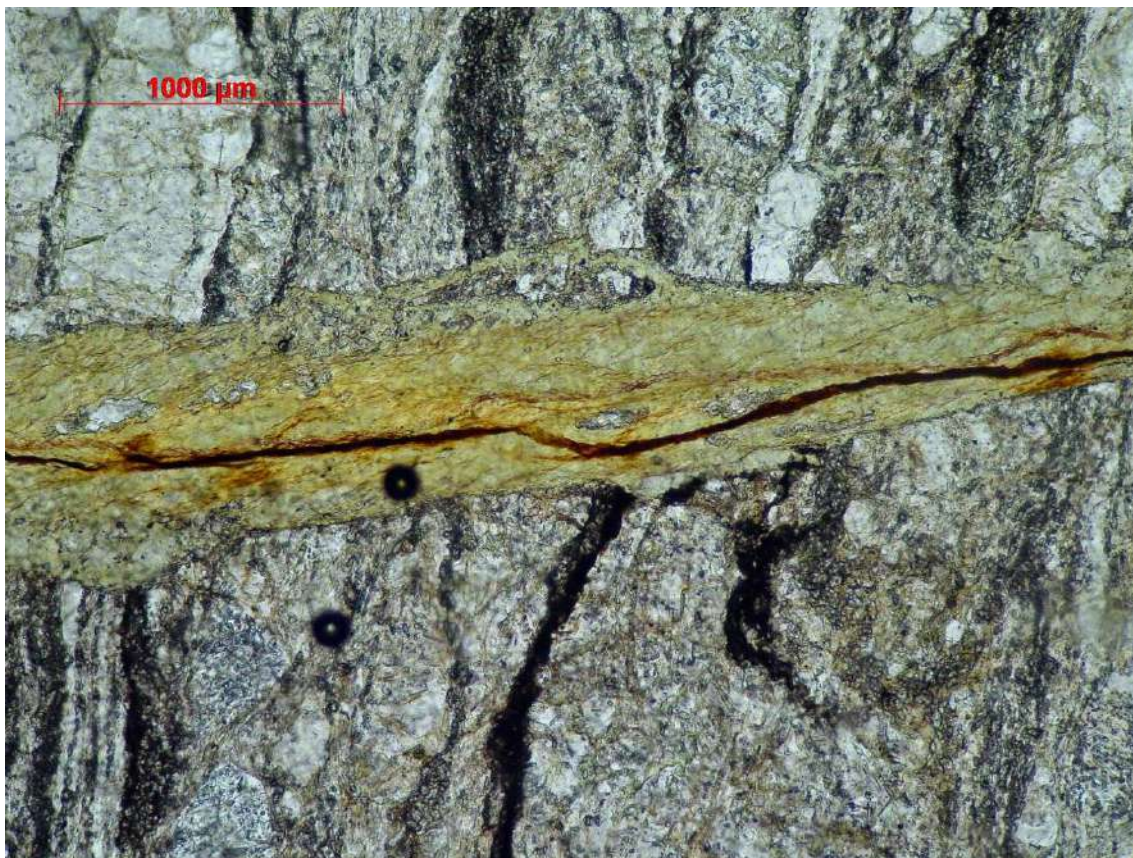
FIGURA 60 – PLANO DE FALHA PREENCHIDO POR CLORITA, EXIBINDO UM CISALHAMENTO ASSOCIADO À REATIVAÇÃO DESSAS FALHAS. ORTOGNAISSE DO COMPLEXO CAMPOS GERAIS. PONTO 114.
