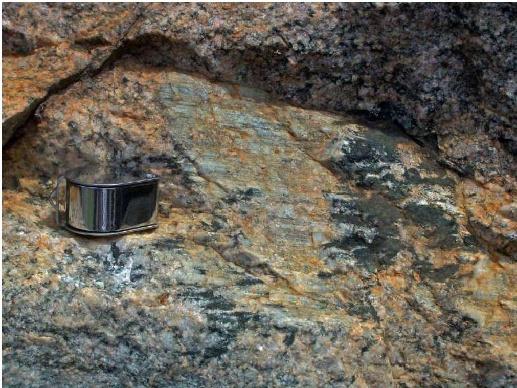
FIGURA 37 – PLANO DE FALHA REVERSA OBLÍQUA PREENCHIDO POR CLORITA MOSTRANDO ESTRIAS ( 293^{\circ}/15^{\circ} ) E 'SLICKENSIDE' INDICANDO TRANSPORTE DE TOPO PARA ESE, NO COMPLEXO CAMPOS GERAIS. PONTO 33. ORIENTAÇÃO: E-W.
