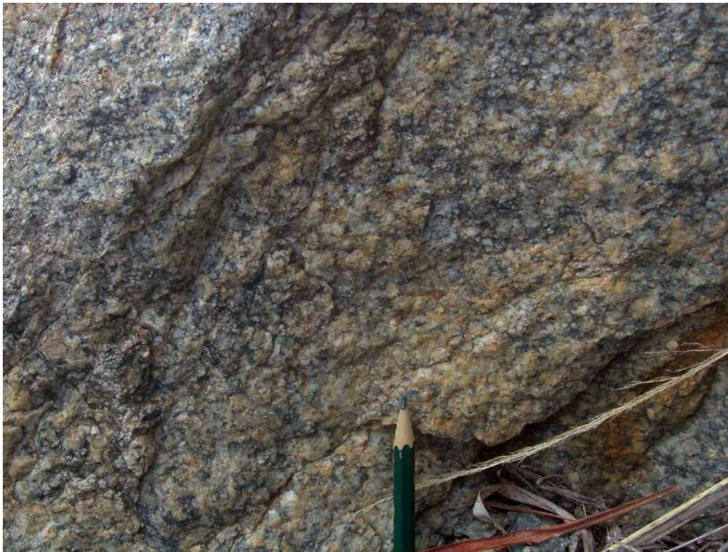
FIGURA 21 – TEXTURA INEQUIGRANULAR PORFIRÍTICA DO GRANITO PORTO DOS MENDES. PONTO 39. ORIENTAÇÃO: NE-SW.
