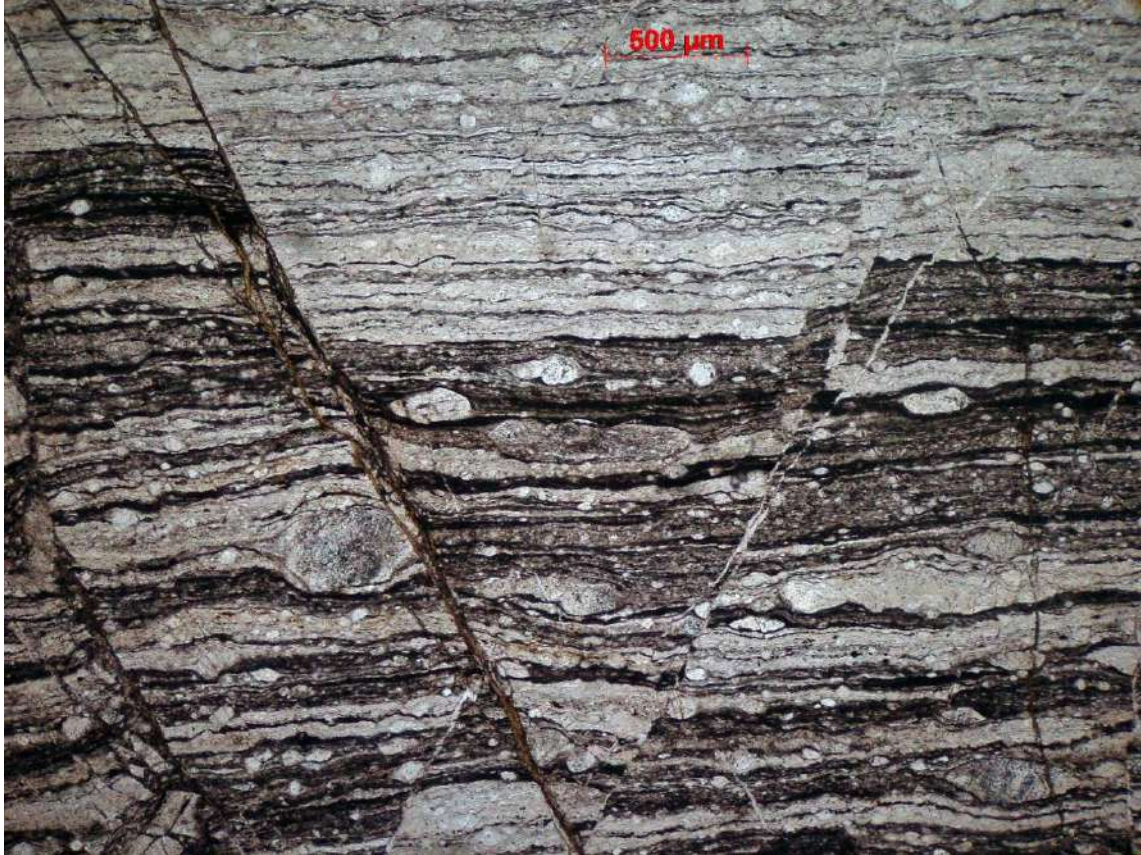
FIGURA 57 – FALHAS CORTANDO A FOLIAÇÃO MILONÍTICA EM ORTOGNAISSE DO COMPLEXO CAMPOS GERAIS. PONTO 114.
