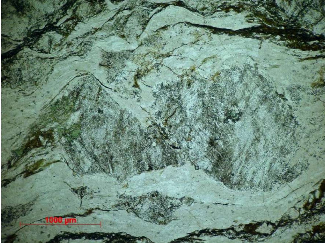
FIGURA 51 – ESTRUTURA EM DOMINÓ COM MOVIMENTO DESTRAL INTERNO E SINISTRAL EXTERNO, INDICANDO TRANSPORTE DE TOPO PARA ENE. ORTOGNAISSE DO COMPLEXO CAMPOS GERAIS. PONTO 3. ORIENTAÇÃO: ENE-WSW.
