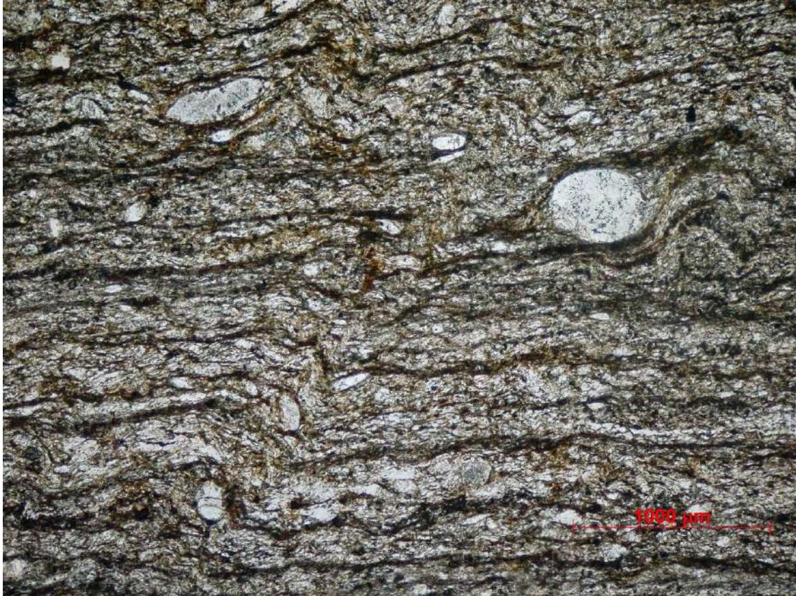
FIGURA 52 – SIGMA E DOBRAS ASSIMÉTRICAS DESTRAIS, COM TRANSPORTE DE TOPO PARA LESTE EM ORTOGNAISSE DO COMPLEXO CAMPOS GERAIS. PONTO 26. ORIENTAÇÃO: W-E.
