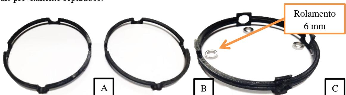
Figura 32- Foto do círculo de movimentação horizontal, pós-impresso. A e B são metades que foram unidas para a construção da peça final, em (C).
