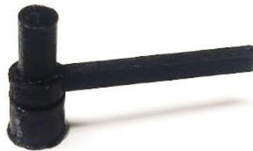
Figura 36 - Eixo Motor 2 sem *jumper* para contato.
