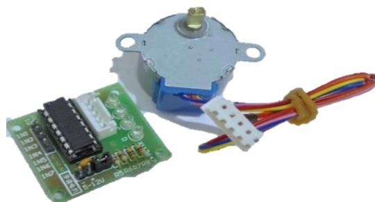
Figura 13 - Motor de passo 28BYJ-48, modelo RioRand, conectado a placa controladora com
