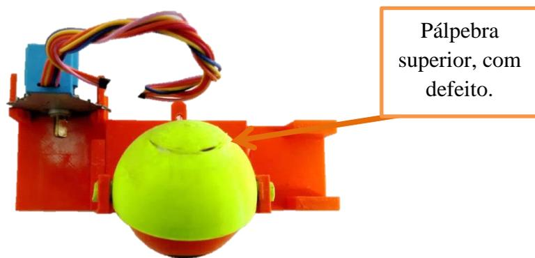
Figura 21- Vista superior do modelo unidimensional, referenciando o problema de impressão.
