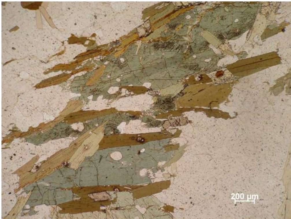
Figura 20. Hornblenda e biotita definindo foliação no Ortognaisse São Gonçalo. Aparecem ainda allanita, epidoto, titanita e zircão. A matriz clara é de quartzo e feldspatos.
